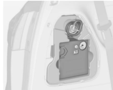
Se o veículo possuir um kit de reparação de pneus, retirar a caixa completa.
