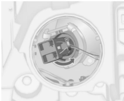
2. Rodar o suporte da lâmpada para a esquerda para desengatar. Afastar o suporte da lâmpada do reflector.
