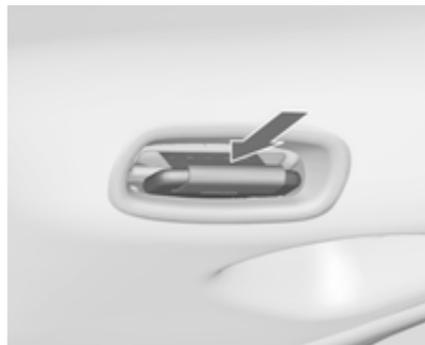
Inserir no suporte do cinto de segurança no tecto com a placa de engate inferior virada para a frente.
