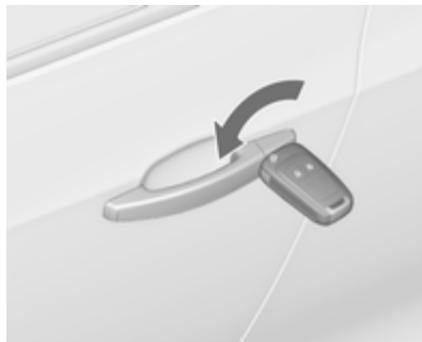
Destrancar manualmente a porta do condutor rodando a chave na fechadura. Ligar a ignição e pressionar o botão do fecho centralizado
