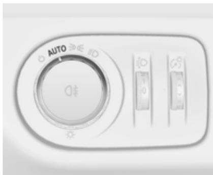
Quando a função de controlo automático das luzes está ligada e o motor está a trabalhar, o sistema alterna entre luzes de circulação diurna e faróis que dependem automaticamente das condições de luminosidade e da informação dada pelo sistema do sensor de chuva.
