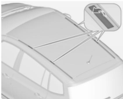
Para fixar uma bagageira de tejadilho, abrir os tampões nos frisos do tejadilho. Introduzir os dispositivos de fixação, conforme as instruções, no retentor ilustrado,
