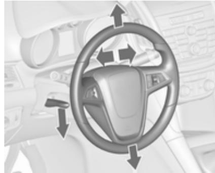
Destancar a alavanca, ajustar o volante, depois engatar a alavanca e assegurar que fica totalmente trancada.
