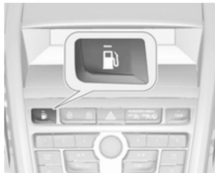
Premir o botão
