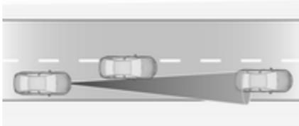
Se outro veículo entrar no trajecto de condução do veículo, o programador de velocidade adaptável só considera o veículo quando este estiver completamente dentro do trajecto.
