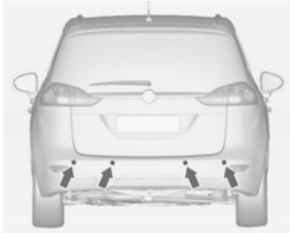
A assistência de estacionamento facilita o estacionamento medindo a distância entre o veículo e os obstáculos emitindo sinais acústicos. É no entanto o condutor que continua totalmente responsável pelo acto de estacionar.
