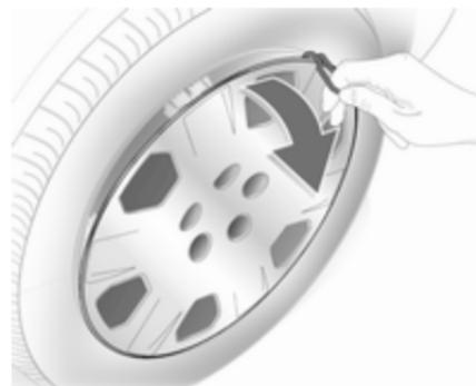
1. Desencaixar as tampas dos parafusos das rodas com uma chave de parafusos e retirar. Retirar o tampão da roda com o gancho. Ferramentas do veículo ↻ 249.
