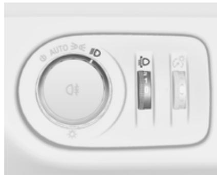
Para adaptar o alcance dos faróis à carga do veículo, para evitar encandeamento: rodar o botão de accionamento manual
