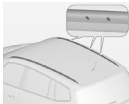
Para fixar uma bagageira de tejadilho, inserir os parafusos de fixação nos orifícios indicados na figura.
