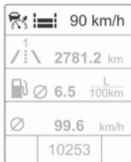
O símbolo do programador de velocidade adaptável, a definição de distância à frente e a velocidade definida são indicados na linha superior do Centro de Informação do Conductor.
