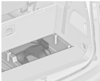
Na versão sem a terceira fila de bancos, existem caixas de arrumação sob a cobertura do piso. Para abrir, levantar a cobertura.
