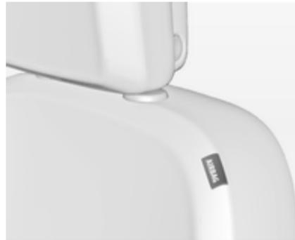
O sistema de airbag lateral é composto por um airbag em cada encosto dos bancos dianteiros. Esses airbags podem ser identificados pela palavra **AIRBAG**.
