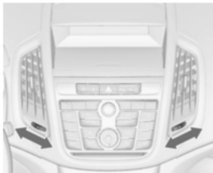
Para abrir a saída de ar, rodar a roda de regulação para I. Ajustar a quantidade de ar na saída de ar, rodando a roda de regulação.
