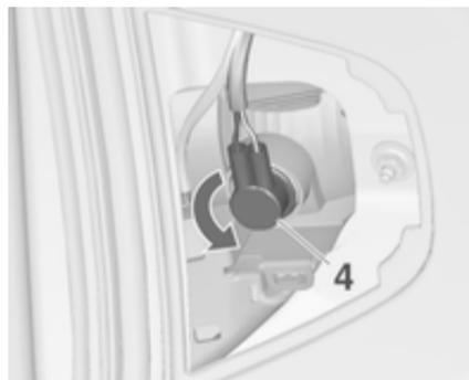
2. Rodar o suporte da lâmpada para a esquerda e retirá-lo do reflector.
