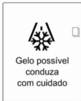
Se a temperatura exterior descer abaixo dos 3 °C, é apresentada uma mensagem de aviso no Centro de Informação do Condutor com Mostrador Avançado ou Mostrador Combinado Avançado
