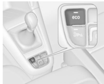
Desactivar manualmente o sistema Start/Stop carregando no botão **eco**. A desactivação é indicada pelo LED que se apaga no botão.
