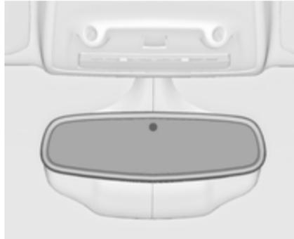
À noite, o encandeamento provocado pelos veículos que seguem atrás é automaticamente reduzido.
