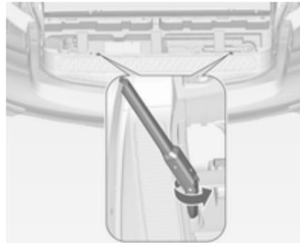
3. Encaixar a chave de rodas no parafuso de cabeça hexagonal e rodar para a esquerda até ser sentida resistência.
