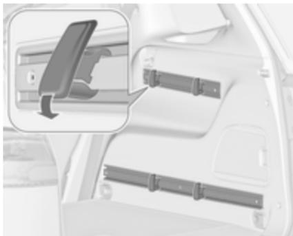
Colocar os ganchos na posição pretendida nas calhas: inserir o gancho na ranhura superior da calha e empurrar para dentro da ranhura inferior.
