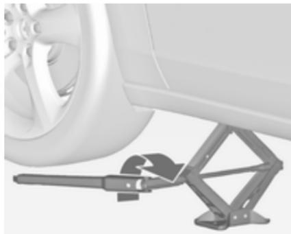
Colocar a chave de rodas e com o macaco bem alinhado rodar a chave de rodas até a roda ficar afastada do solo.
