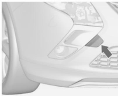
Inserir uma chave de parafusos no rebordo curto da tampa. Soltar a tampa, deslocando cuidadosamente a chave de parafusos para o lado. Para evitar danos, recomenda-se colocar um pano entre a chave de parafusos e o aro.
