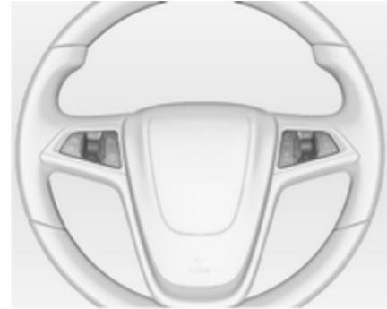
O Sistema de informação e lazer, alguns sistemas de apoio ao condutor e um telemóvel ligado podem ser controlados através dos comandos no volante.
