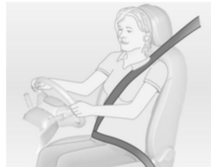
Ajustar a altura de forma a que o cinto fique sobre o ombro. Não deve ficar sobre a garganta ou parte superior do braço.
