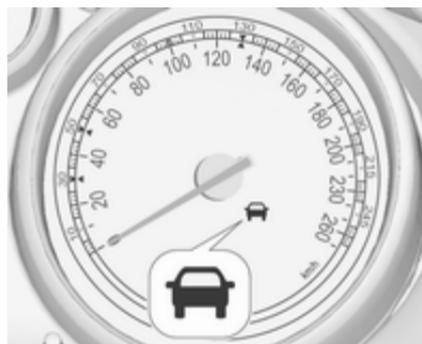
O indicador de controlo de veículo à frente verde aceso aparece no velocímetro quando o sistema detecta um veículo no trajecto de condução.
