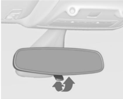
Para reduzir o encandeamento, ajustar a alavanca na parte inferior da caixa do espelho retrovisor.
