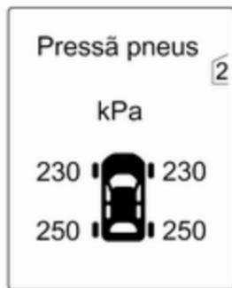
Rodar a roda de regulação para seleccionar o sistema de monitorização da pressão dos pneus.
