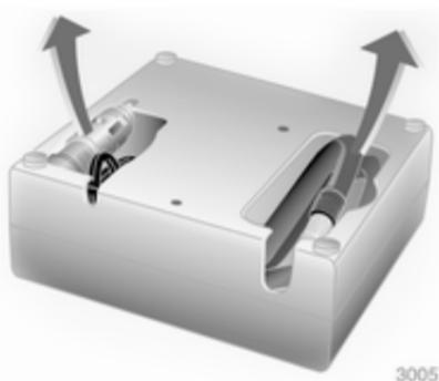
3. Retirar o cabo de ligação eléctrica e tubo flexível de ar do compartimento de arrumação que se encontram na parte inferior do compressor.
