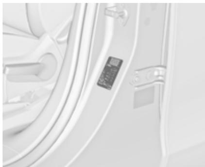
Pressão dos pneus ⇨ 284 e na etiqueta na estrutura da porta esquerda dianteira.
