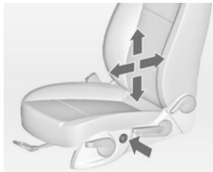
Ajustar o apoio lombar usando o interruptor de quatro vias para o adaptar às necessidades pessoais. Deslocar o apoio para cima e para baixo: pressionar interruptor para cima ou para baixo.
