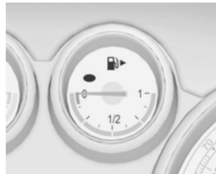
Indica o nível do combustível ou a pressão do gás no depósito, consoante o modo de funcionamento.
