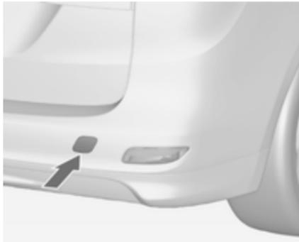
Inserir uma chave de parafusos no rebordo inferior da tampa. Soltar a tampa deslocando cuidadosamente a chave de parafusos para baixo. Para evitar danos, recomenda-se colocar um pano entre a chave de parafusos e o aro.
