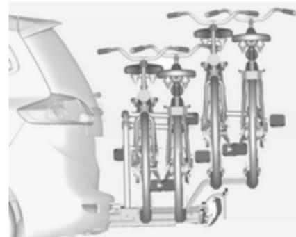
O sistema de suporte traseiro (sistema Flex-Fix) permite a fixação de duas bicicletas num suporte extraível integrado na base do veículo. É possível fixar duas bicicletas adicionais num adaptador. O transporte de outros objectos não é permitido.
