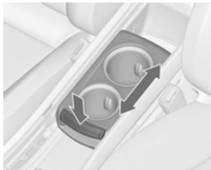
Pressionar a pega na parte da frente do suporte para bebidas para deslizar.
