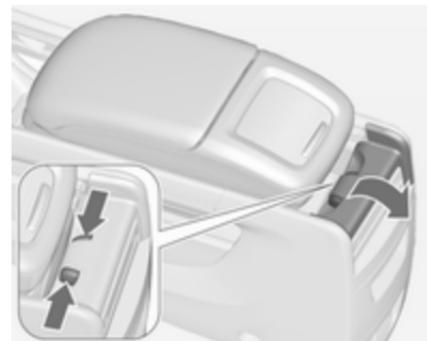
Premir os fechos para dentro e puxar para baixo o mecanismo de travagem na parte posterior do apoio de braços.
