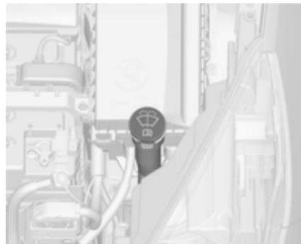
Encher com água limpa misturada com uma quantidade adequada de líquido do limpa-vidros que contenha anticongelante. Para a proporção de mistura correcta, consultar o recipiente do líquido do limpa-vidros
