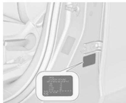
A placa de identificação encontra-se na estrutura da porta dianteira esquerda.
