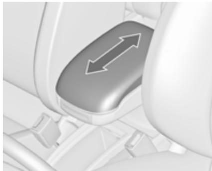
O apoio de braços pode ser deslizado para a frente. Sob o apoio de braços existe uma gaveta para arrumação.
