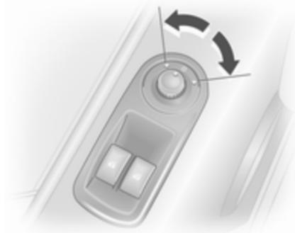
Seleccionar o espelho retrovisor exterior em questão, accionando o comando para a esquerda ou para a direita e depois rodar o comando para regular o espelho.
