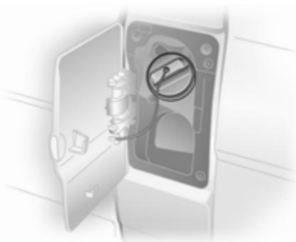
Para desbloquear e abrir o tampão do combustível, inserir a chave e virar no sentido contrário aos ponteiros do relógio. Quando o reabastecimento estiver completo, substituir o tampão e rodar a chave no sentido dos ponteiros do relógio, até ao seu ponto máximo.
