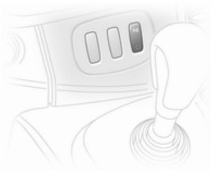
É possível utilizar o modo de carga, em ambos os modos automático e manual. Em ambos os casos, os padrões de mudança de engrenagem são automaticamente adaptados para transportar uma grande carga útil.
