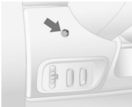
Além do comando à distância, o aquecimento também pode ser ligado durante 30 minutos ou desligado com o auxílio do botão no painel de instrumentos.
