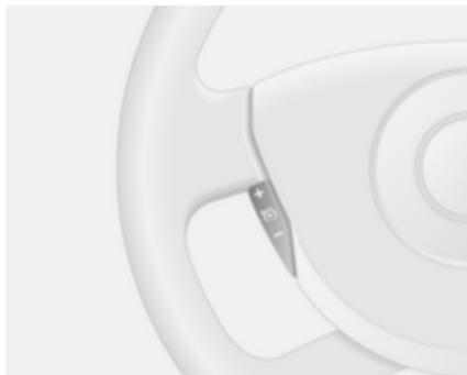
Acelerar até à velocidade pretendida e pressionar novamente **+** ou **-**. A velocidade actual é então guardada e mantida e o pedal do acelerador pode ser libertado.
