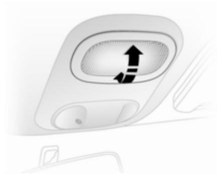
Conforme o veículo, as luzes interiores podem ser accionadas com um interruptor ou inclinando as lentes ópticas para uma das 3 posições, p.ex.:
