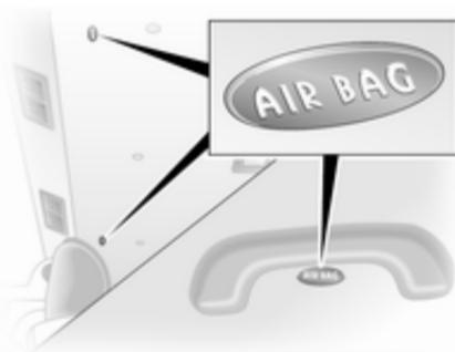
O sistema de airbags de cortina é composto por um airbag montado na estrutura do tejadilho, um de cada lado. Esses airbags podem ser identificados pela palavra **AIRBAG** no revestimento do tecto.
