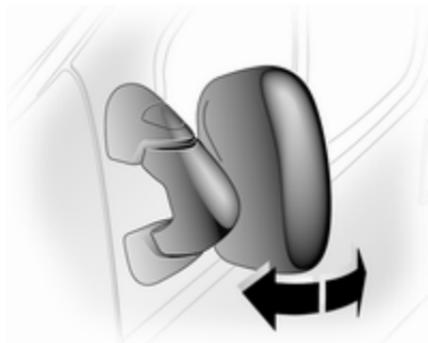
Para segurança de peões, os espelhos retrovisores exteriores serão rebatidos se levarem um encontro suficientemente forte. Reposicionar o espelho retrovisor aplicando uma ligeira pressão na caixa do espelho.
