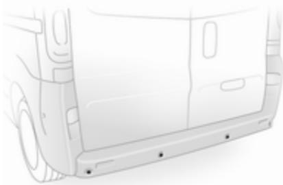
O auxiliar de estacionamento facilita o estacionamento em marcha-atrás medindo a distância entre a parte de trás do veículo e os obstáculos. É no entanto o condutor que é o responsável por estacionar.
