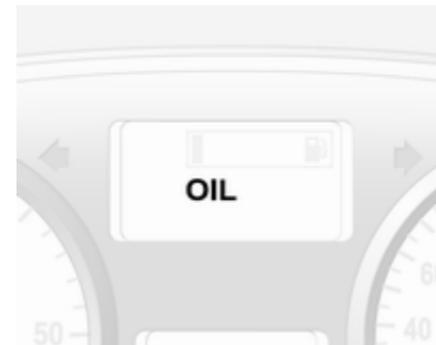
Se for atingido o nível mínimo do óleo de motor, é apresentada a mensagem **OIL** no Centro de Informação do Condutor durante 30 segundos depois de a ignição ser ligada. Verificar o nível do óleo ↷ 124.
