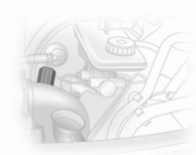
Nalguns modelos, existe um indicador no sistema de indução do motor que indica se a entrada de ar para o motor está restringida.
