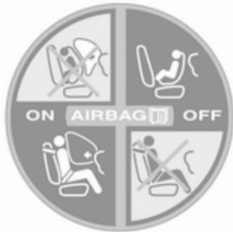
O sistema de desactivação do airbag é indicado por uma etiqueta no lado do painel de instrumentos, visível ao abrir a porta do passageiro da frente.
