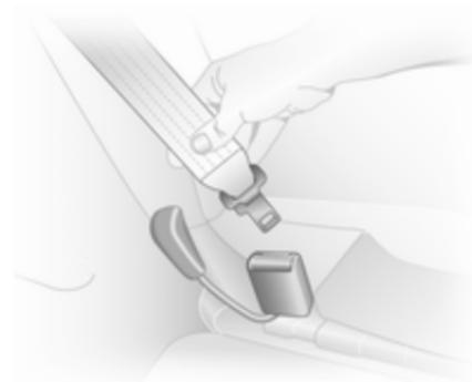
Antes de colocar o cinto, inserir primeiro a lingueta metálica inferior na fivela, no lado exterior do banco.
