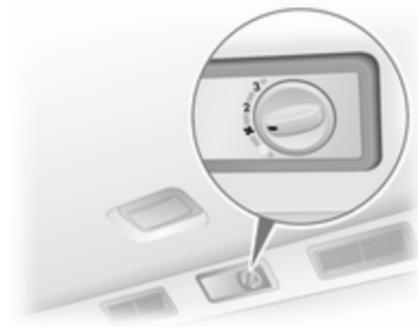
A velocidade do fluxo do ar é determinada pela ventoinha. A temperatura do ar é controlada utilizando o controlo de temperatura no painel de instrumentos.
