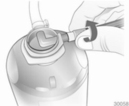
3. Aparafusar o tubo flexível do compressor na ligação na botija do vedante.
