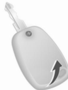
Retirar o parafuso e abrir o compartimento da bateria inserindo uma moeda na ranhura e rodando.
