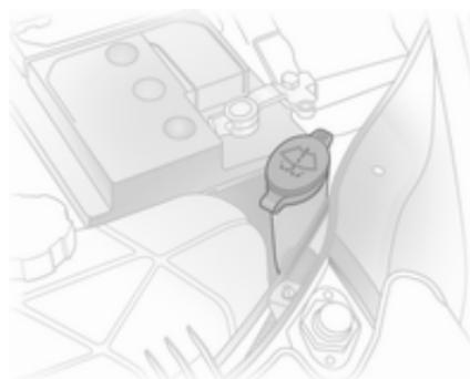
Encher com água limpa misturada com uma quantidade adequada de líquido de limpa-vidros que contenha anti-congelante. Para a proporção de mistura correcta, consultar o recipiente do líquido do limpa-vidros
