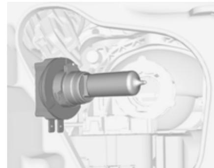
3. Introduzir uma nova lâmpada no refletor para que a placa de localização do suporte de lâmpada fique alinhada com a reentrância do refletor.
