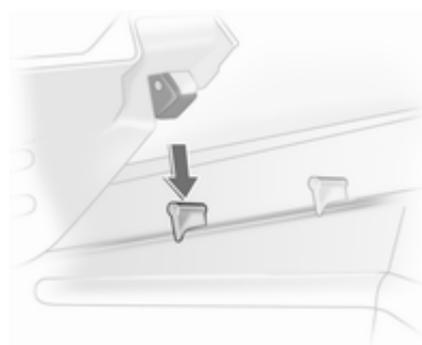
Para remover os outros 3 segmentos (ordem 2 a 4) levantar atrás, desencaixar, rodar e remover.
