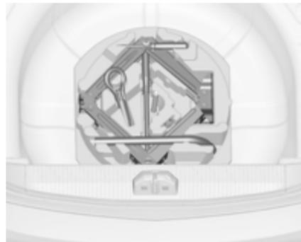
Variante 1: o macaco e as ferramentas do veículo encontram-se na bagageira por baixo da roda sobresselente. Uma etiqueta no macaco indica os veículos em que o macaco pode ser utilizado.
