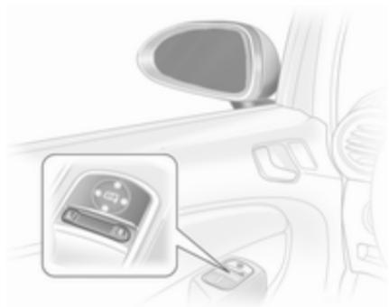
Primeiro seleccionar o espelho retrovisor exterior e depois utilizar o controlo a ajustar.
