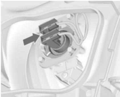
2. Pressionar a base para o lado e remover a lâmpada do refletor.
