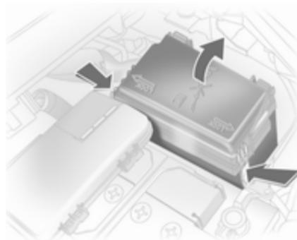
A caixa de fusíveis encontra-se na parte da frente esquerda do compartimento do motor.
