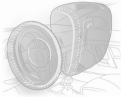
O movimento para a frente dos ocupantes dos bancos dianteiros é desacelerado, reduzindo assim consideravelmente o risco de lesões no tronco e cabeça.
