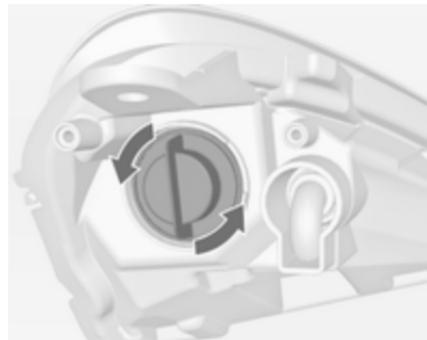
1. Rodar o suporte da lâmpada **3** para a esquerda para desencaixar.
