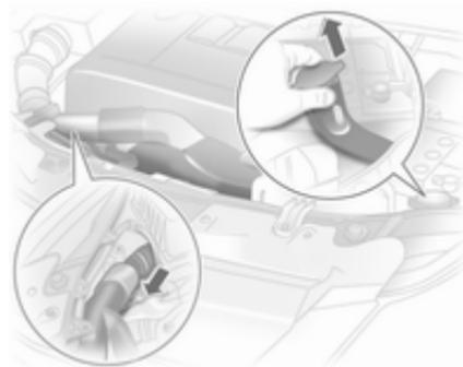
Para substituir lâmpadas do lado direito do compartimento do motor, soltar o tubo flexível do ar do filtro do ar.
