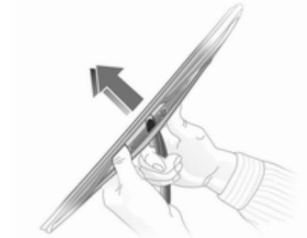
Levantar o braço do limpa-vidros. Desengatar a escova do limpa-vidros conforme ilustrado na figura e retirar. Fixar ao braço do limpa-vidros a escova limpa-vidros de forma ligeiramente angulada e empurrar até encaixar.
