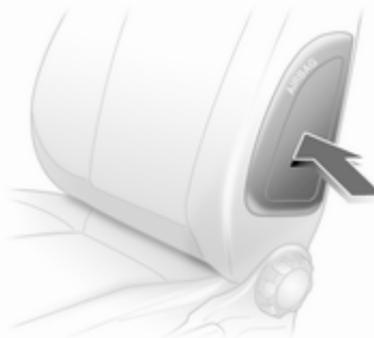
O sistema de airbags laterais é composto por um airbag em cada um dos encostos dos bancos dianteiros. Esses airbags podem ser identificados pela palavra **AIRBAG**.
