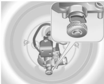
Rodar para a direita a roda selectora manual.
