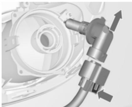
2. Desencaixar o suporte da lâmpada da ligação da ficha, pressionando a presilha de retenção.
