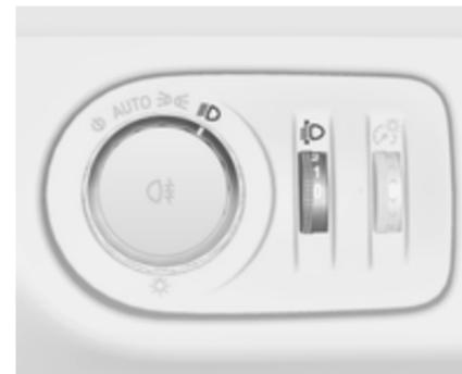
Para adaptar o alcance dos faróis à carga do veículo para evitar encandeamento: Rodar o botão de accionamento manual até a definição pretendida estar visível no visor de quilómetros.
