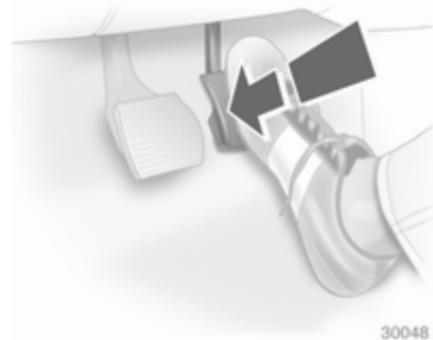
Se o pedal do acelerador for premido para além do ponto de pressão, a caixa de velocidades passa para uma mudança inferior consoante a velocidade do motor.
