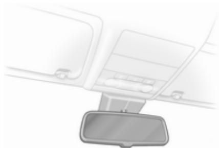
À noite, o encandeamento provocado pelos veículos que seguem atrás é automaticamente reduzido.
