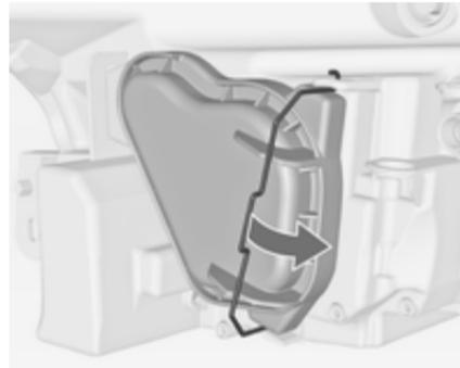
1. Desencaixar o grampo e remover a cobertura protectora 1.
