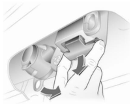
Desengatar e rebater a tomada. Retirar o tampão de vedação da abertura da barra da esfera de acoplamento e arrumar.
