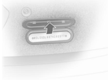
O número de identificação do veículo encontra-se na placa de identificação e no painel do piso, por baixo da cobertura do piso, visível por baixo de uma tampa.
