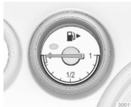
Indica o nível do combustível ou o nível do gás no depósito, consoante o modo de funcionamento.
