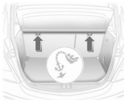
Conforme o equipamento específico de cada país, o veículo pode ter dois ou três olhais de fixação.
