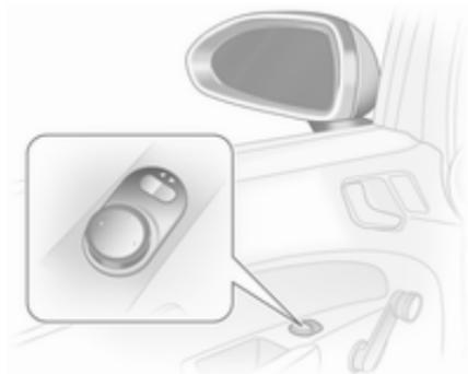
Primeiro seleccionar o espelho retrovisor exterior e depois utilizar o controlo a ajustar.
