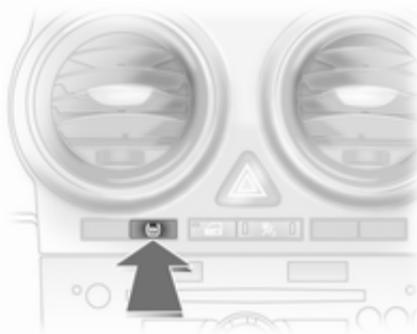
Depois de corrigir a pressão de um pneu ou de mudar uma roda, é preciso inicializar o sistema: Ligar a ignição e premir o botão **DDS** durante aproximadamente 4 segundos. O indicador de controlo (U) pisca três vezes.
