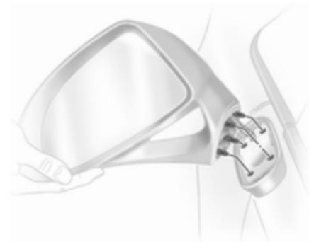
Corsa OPC: Para segurança dos peões, os espelhos exteriores do Corsa OPC são libertados do suporte se sofrerem algum impacto. Encaixar a caixa do espelho no suporte com grampos de fixação e engate batendo levemente.
