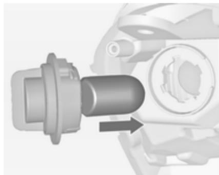
2. Retirar a lâmpada do encaixe e inserir uma nova lâmpada.
