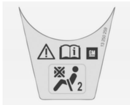
Existe uma etiqueta de aviso na parte lateral do painel de instrumentos, visível quando a porta do passageiro da frente está aberta.
