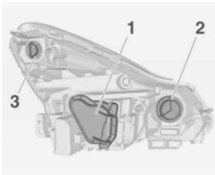
Os faróis têm sistemas separados para luzes de médios e de máximos 1(lâmpada exterior), lâmpada para curvas 2 (lâmpada interior) e luzes de condução diurna/luzes laterais 3.
