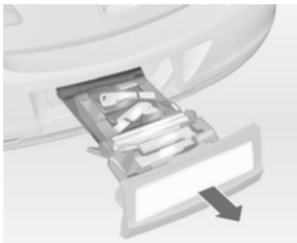
Puxar completamente para fora o sistema de transporte traseiro até se ouvir o encaixe do sistema.
