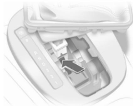
3. Empurrar o engate amarelo para a frente com uma chave de fendas e movimentar a alavanca para fora de **P**. Se engrenar novamente **P**, a alavanca selectora volta novamente à posição de bloqueada. Reparar a causa da interrupção de alimentação eléctrica numa oficina.
