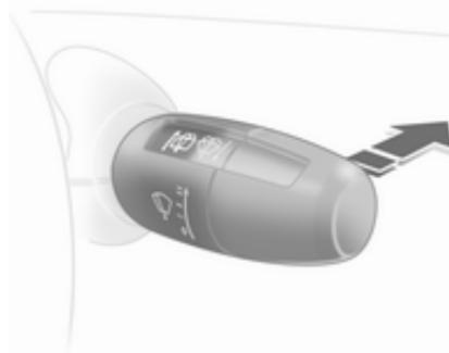
Empurre a alavanca para a frente. O limpa pára-brisas traseiro efectua passagens intermitentes. Desligar empurrando a alavanca novamente para a frente.
