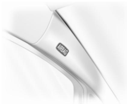
O sistema de airbags de cortina é composto por um airbag montado na estrutura das janelas, um de cada lado. Podem ser identificados pela palavra **AIRBAG** nos pilares do tejadilho.
