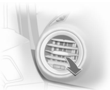
Para fechar a ventilação, rodar a roda de ajuste para a esquerda ou para a direita até parar.
