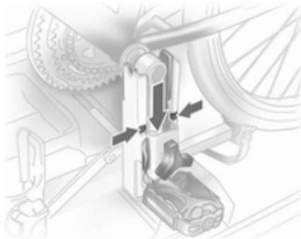
Inserir por cima, o encaixe da pedaleira na calha exterior de cada nicho da pedaleira e deslizá-la para baixo até pelo menos por baixo dos entalhes.
