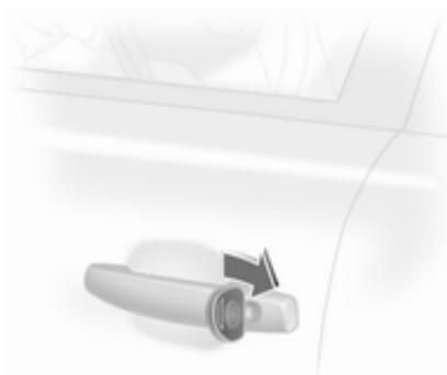
Rodar para trás a chave na fechadura da porta do condutor.
