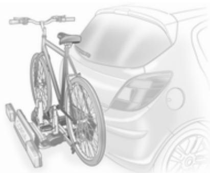
O sistema de suporte traseiro (sistema Flex-Fix) permite segurar bicicletas num transportador integrado no piso do veículo que é puxado para fora. O transporte de outros objectos não é permitido.
