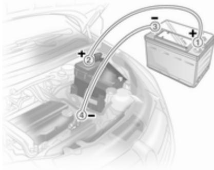
Colocar os cabos de modo a não serem apanhados por peças rotativas no compartimento do motor.
