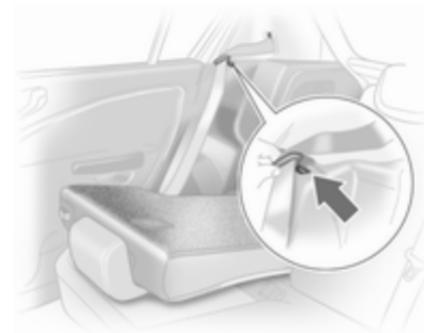
Mover os encostos dos bancos traseiros para a posição vertical e permitir que os mecanismos de fecho encaixem de forma sonora em ambos os lados. Uma vez trancados os encostos deixará de ser ver a marca vermelha.
