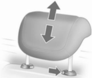
A altura do encosto de cabeça pode ser configurada para duas posições. Para configurar para a primeira posição, puxe o encosto de cabeça para cima, na segunda posição pressione a mola assinalada na imagem e empurre o encosto de cabeça para cima até ao máximo. Para ajustar para baixo, pressionar a mola assinalada na imagem e empurrar o encosto de cabeça para baixo.
