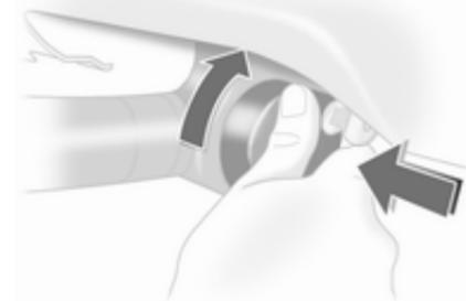
Introduzir a chave na fechadura e desbloquear a barra esférica de acoplamento.
