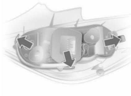
5. Pressionar suavemente os três terminais de bloqueio no exterior do suporte da lâmpada para fora e remover o suporte da lâmpada.
