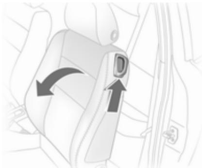
Levantar a alavanca de abertura e inclinar o encosto para a frente. Baixe a alavanca de abertura e o encosto encaixa numa posição mais baixa. Deslize o banco para a frente.
