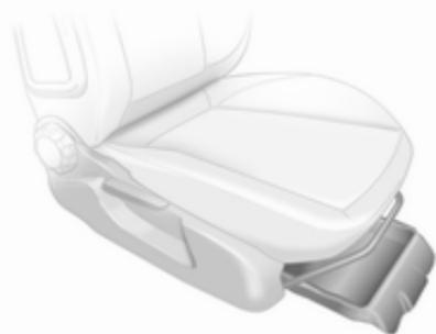
Levantar na extremidade com reentrância e puxar para fora. Carga máxima: 1,5 kg. Para fechar, empurrar e engatar.
