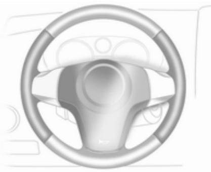
O volante é aquecido nas áreas ilustradas na figura quando o motor está a trabalhar e durante um Autostop.
