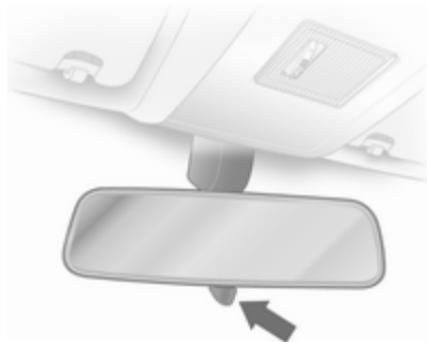
Utilizar a alavanca na parte inferior para reduzir o encandeamento.
