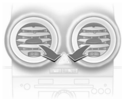
Definir a direcção do fluxo do ar rodando a roda de ajuste da direita para a esquerda e levantando ou baixando as ranhuras horizontais.
