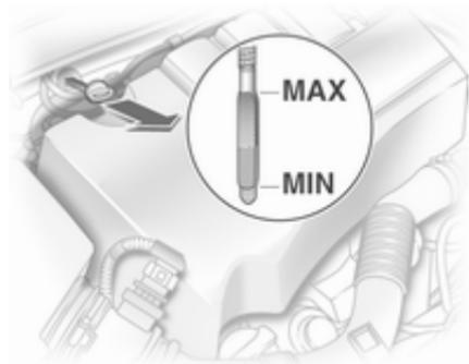
Quando o nível do óleo de motor for inferior à marca **MIN**, atestar com óleo de motor.
