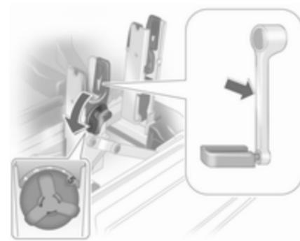
Com a alavanca de rotação sobre a superfície do pedal, adaptar os pedais ajustáveis à unidade da superfície do pedal até à saliência da superfície do pedal.
