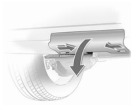
Empurrar ambos os parafusos para dentro e remover a cobertura no pára-choques.
