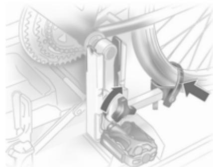
Aperte manualmente os parafusos de fixação da armação do rolamento do pedal até ao máximo.
