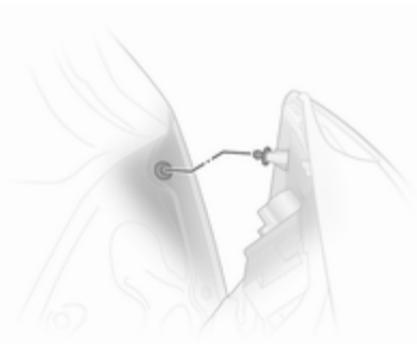
9. Introduzir a caixa da lâmpada na carroçaria do veículo, apertando as porcas de fixação manualmente. Encaixar o conector de encaixe. Fechar cobertura.
