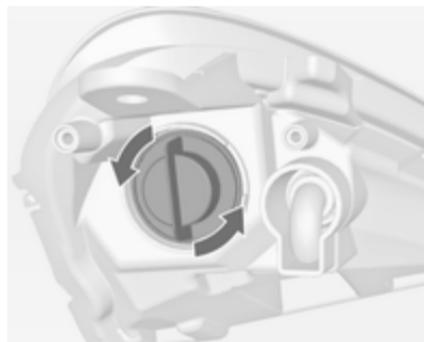
1. Rodar o suporte da lâmpada **3** para a esquerda para desencaixar.
