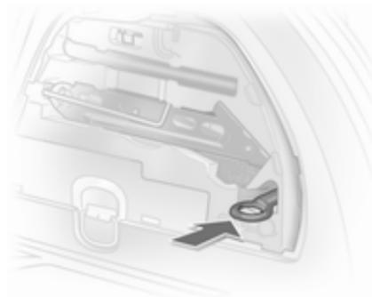
O olhal de reboque está arrumado com as ferramentas do veículo  $\varnothing$  181. O olhal de reboque está localizado numa reentrância.
