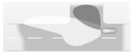
Em curvas apertadas ou em inversão de marcha, dependendo do ângulo de direcção ou do sinal luminoso do indicador, um reflector esquerdo ou direito adicional é ligado para iluminar a estrada na direcção de deslocação. É accionado até uma velocidade de 40 km/h.
