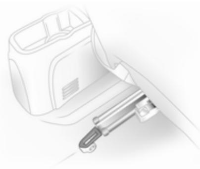
No friso do pilar no tejadilho traseiro e nos pontos de encaixe existem símbolos que indicam os olhais de fixação onde deve ser montado o sistema de retenção para crianças.
