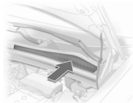
As entradas de ar à frente do pára-brisas no compartimento do motor deverão permanecer desobstruídas de modo a permitir a entrada de ar. Retirar quaisquer folhas, sujidade ou neve.
