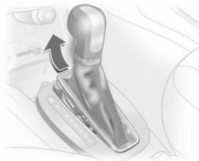
2. Soltar o forro da alavanca selectora na parte dianteira da consola central, dobrar para cima e rodar para a esquerda.
