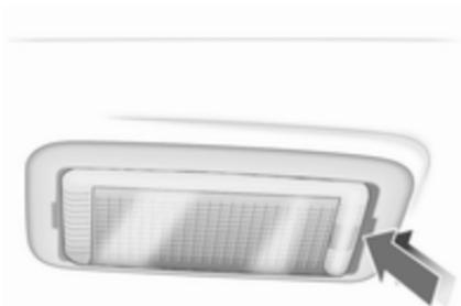
1. Retirar a lâmpada para fora com uma chave de parafusos.
