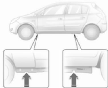
3. Certificar-se de que o macaco está bem colocado nos pontos de elevação com macaco do veículo. Com versões do Corsa OPC com painéis de borda ou painéis de porta melhorados não deve ser usado nenhum macaco hidráulico. O veículo pode estar danificado.
