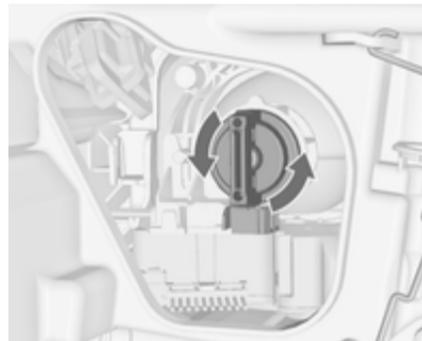
2. Rodar o suporte da lâmpada para a esquerda para desengatar. Retirar do refletor o suporte da lâmpada.
