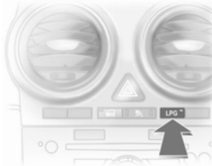
Premir o botão **LPG** comuta entre o funcionamento a gasolina e a gás liquefeito. O estado do LED
