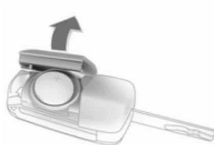
Extrair a chave e abrir a unidade. Substituir a pilha (pilha tipo CR 2032), prestando atenção à posição de colocação. Fechar a unidade e sincronizar.
