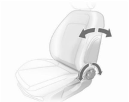
Rodar roda de ajuste. Não se encostar no banco quando se estiver a proceder ao ajuste.
