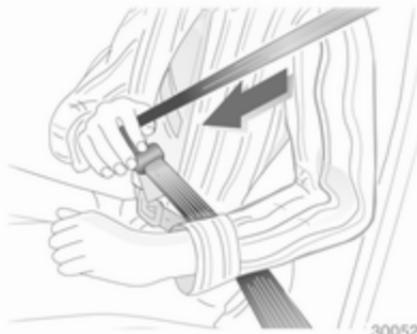
Puxar do enrolador, sem torcer, colocar sobre o corpo e inserir a lingueta metálica no fecho. Ajustar a tensão da faixa do cinto que passa pelo abdómen regularmente puxando a faixa que passa pelo ombro.
