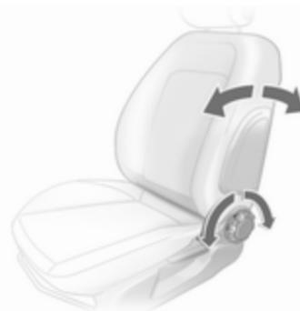
Rodar roda de ajuste. Não se apoiar no encosto do banco quando se estiver a proceder ao ajuste.
