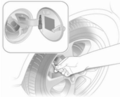
A pressão dos pneus ⇨ 227 e na etiqueta na lateral da portinhola de enchimento do depósito de combustível ou na estrutura da porta dianteira direita.
