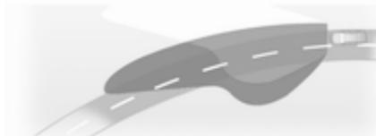
Os feixes dos faróis rodam conforme o ângulo do volante e a velocidade, melhorando a iluminação nas curvas.
