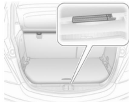
Arrume o triângulo de pré-sinalização na parede traseira da bagageira: primeiro encaixe o triângulo de sinalização no espaço à esquerda e depois introduza a guia na direita.
