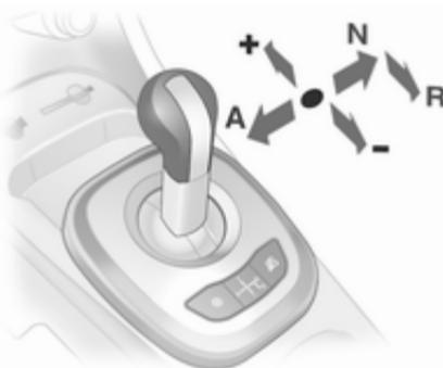
Deslocar sempre a alavanca selectora na direcção apropriada o mais possível. Depois de a largar, volta automaticamente para a posição central.
