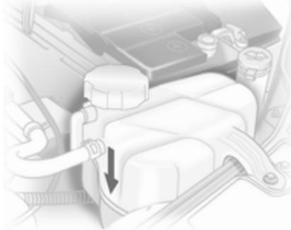
Se o sistema de arrefecimento estiver frio, o nível do líquido de arrefecimento deve estar acima da marca **KALT/COLD**. Atestar se o nível estiver baixo.
