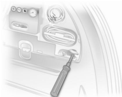
As ferramentas do veículo estão no compartimento do lado direito na bagageira, juntamente com o kit de reparação de pneus.
