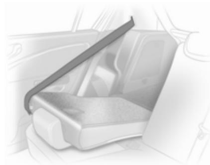
Desencaixar o encosto dos bancos (simples ou repartido) usando a alavanca de abertura e dobre-a para baixo para a almofada do assento.
