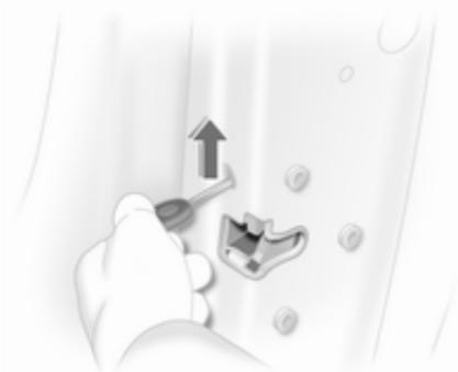
Inserir a chave na abertura por cima da fechadura do lado de dentro da porta e accionar a fechadura levantar até se ouvir um estalido. Depois fechar a porta. O procedimento deve ser realizado para cada uma das portas. A porta do condutor pode também ser trancada do lado de fora com a chave. A portinhola do depósito de combustível e a porta da retaguarda não podem ser trancadas.
