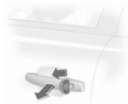
Rodar para a frente a chave na fechadura da porta do condutor.
