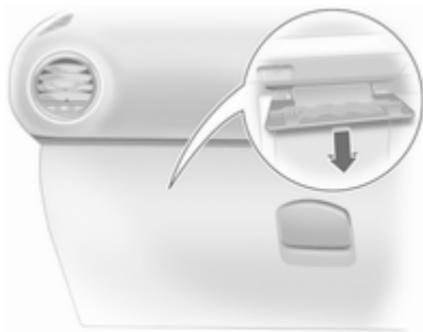
Em veículos com volante à direita, a caixa dos fusíveis encontra-se atrás de uma tampa no porta-luvas. Abrir o porta-luvas e retirar a tampa. Para fechar, primeiro colocar a cobertura, depois bloqueá-la em posição.
