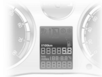
O computador de bordo fornece informação sobre os dados de condução, que é gravada e avaliada eletronicamente de forma contínua.
