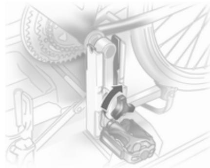
Anexar a superfície do pedal ao rodar o parafuso de anexo na montagem do pedal.
