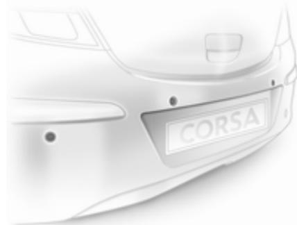
O auxiliar de estacionamento facilita o estacionamento medindo a distância entre o veículo e os obstáculos. É no entanto o condutor que continua totalmente responsável por estacionar.
