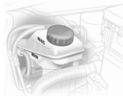
O nível do líquido dos travões deve situar-se entre as marcas **MIN** e **MAX**.
