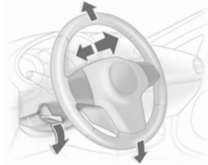
Destrancar a alavanca, ajustar o volante, e depois engatar a alavanca e assegurar que fica totalmente trancada. Ajustar o volante apenas quando o veículo estiver parado e o volante tiver sido destrancado.
