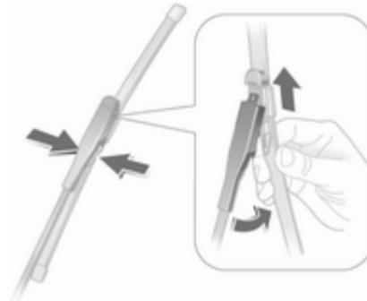
Levantar o braço do limpa-vidros, inclinar a escova do limpa pára-brisas a 90° do braço do limpa-vidros e remover para o lado.
