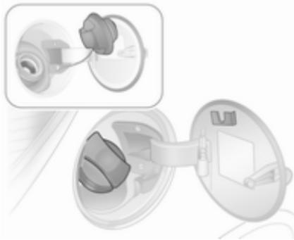
Desbloquear a portinhola do depósito de combustível com a chave de ignição. Para abrir, rodar a tampa lentamente para a esquerda. A tampa do tubo de enchimento de combustível pode ser colocada no suporte, na portinhola do depósito de combustível.
