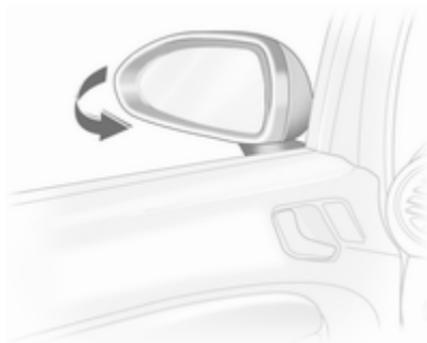
Os espelhos retrovisores exteriores podem ser rebatidos empurrando a extremidade exterior da caixa, com cuidado.
