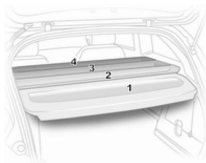
A cobertura do compartimento de carga tem quatro segmentos que podem ser removidos individualmente e inseridos.
