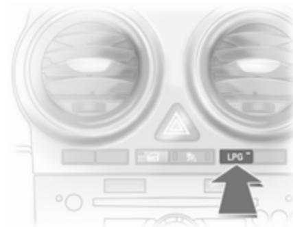
Premindo o botão **LPG** comuta entre o funcionamento a gasolina e a gás liquefeito logo que os parâmetros necessários (temperatura do líquido de arrefecimento, temperatura do gás e rotação mínima do motor) tenham sido atingidos. Os requisitos são atingidos após aproximadamente 60 segundos (consoante a temperatura exterior) e a primeira vez que o acelerador é pressionado com mais intensidade. O estado do LED mostra o modo de funcionamento actual.
