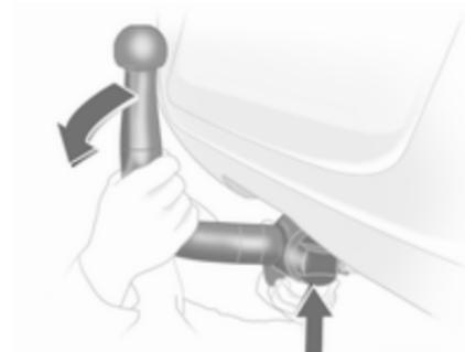
Inserir a barra da esfera de acoplamento sob tensão na abertura e empurrar com firmeza para cima até se ouvir um estalido, sinal de encaixe.
