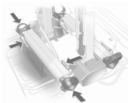
Pressionar a alavanca de abertura e deslizar os intervalos das rodas completamente até onde cheguem.
