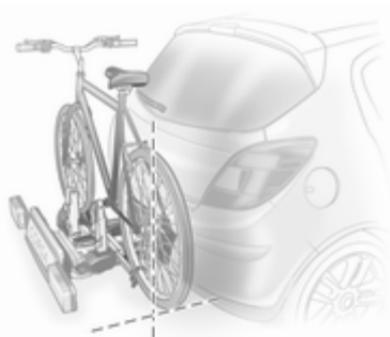
Alinhar a bicicleta na direção longitudinal do veículo: Desapertar um pouco a estrutura do pedal.
