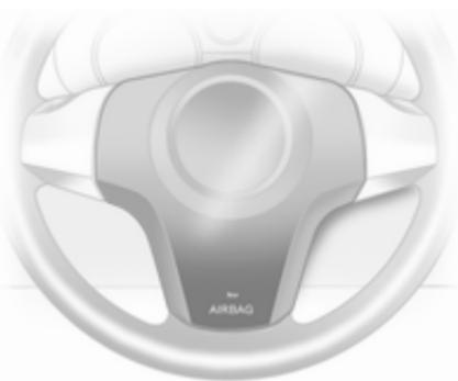
O sistema de airbags dianteiros é composto por um airbag no volante e um no painel de instrumentos no lado dianteiro do passageiro. Esses airbags podem ser identificados pela palavra **AIRBAG**.
