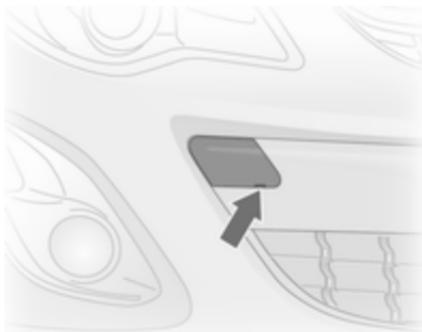
Inserir uma chave de parafusos na fenda existente na curvatura inferior da tampa. Soltar a tampa deslocando cuidadosamente a chave de parafusos para baixo.
