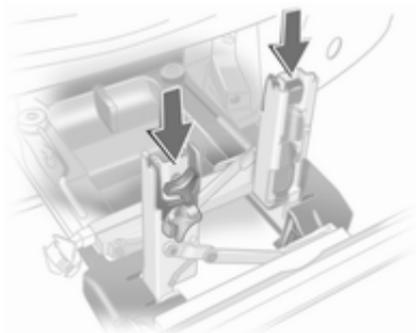
Empurrar os apoios da superfície do pedal na reentrância da superfície do pedal como mostra a figura.
