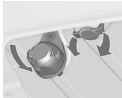
Desengatar e baixar a tomada. Retirar a tampa de vedação da abertura para a barra da esfera de acoplamento e arrume-a.
