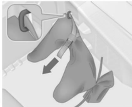
O saco que contém a barra da esfera de acoplamento está arrumado no piso do compartimento de arrumação traseiro.
