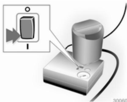
10. Colocar o interruptor de balancim do compressor na posição I. O pneu é cheio com vedante.
