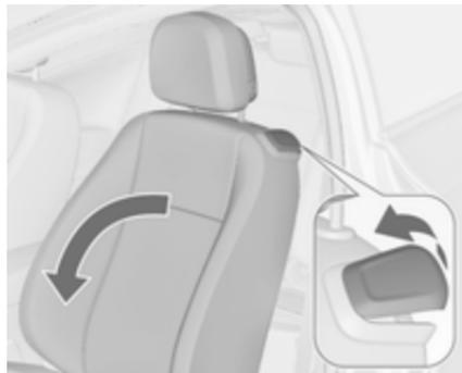
Levantar a alavanca de desengate e rebater o encosto para a frente. Deslize o banco para a frente.
