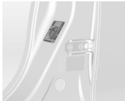
Pressão dos pneus ↻ 221 e na etiqueta na estrutura da porta esquerda dianteira.
