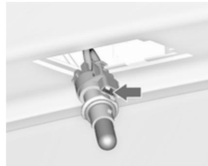
3. Desencaixar a presilha de retenção e retirar o suporte da lâmpada da ficha da cablagem.
