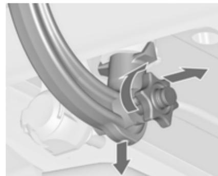
Abriu a aba de protecção e rodar a chave para a posição
