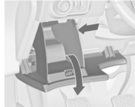
Em veículos com volante à esquerda, a caixa dos fusíveis encontra-se atrás do compartimento de arrumação no painel de instrumentos.
