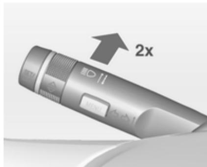
O alcance da iluminação inteligente e a activação automática dos máximos são ambas ligadas simultaneamente premindo duas vezes a alavanca de indicação de mudança de direcção. Podem ser activados com a ignição ligada.
