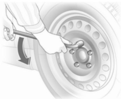
2. Montar a chave de rodas certificando-se que fica bem colocada e soltar cada porca meia volta.
