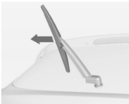
Levantar o braço do limpa pára-brisas. Desencaixar a escova do limpa pára-brisas conforme se mostra na figura e retirar.
