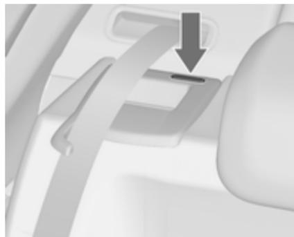
Os encostos estão correctamente encaixados quando as marcas vermelhas nos dois lados perto da alavanca de desengate deixam de se ver.
