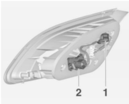
4. Rodar o suporte da lâmpada para a esquerda e retirá-lo do refletor.
