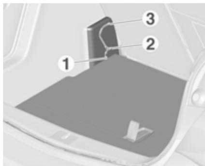
A cobertura regulável em altura pode ser instalada em três posições:
