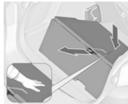
Para baixar a cobertura, puxar a cinta para trás e empurrar para baixo simultaneamente a parte dianteira central da cobertura.
