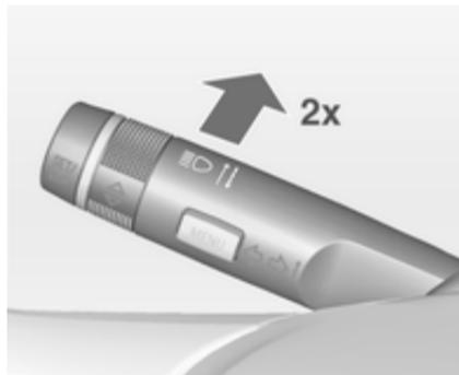
A assistência dos máximos é activada pressionando a alavanca do indicador de mudança de direcção duas vezes com velocidades acima de 40 mph.
