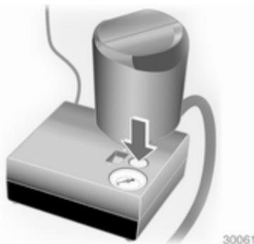
Se a pressão de pneu prescrita não for atingida no espaço de 10 minutos, retirar o kit de reparação de pneus. Deslocar o veículo de forma a que o pneu dê uma volta completa. Voltar a ligar o kit de reparação de pneus e continuar o procedimento de enchimento durante 10 minutos. Se continuar a não atingir a pressão do pneu prescrita, o pneu está demasiado danificado. Recorrer à ajuda de uma oficina.
