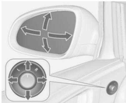
Seleccionar o retrovisor exterior relevante rodando o controlo para a esquerda (**L**) ou a direita (**R**). Depois rodar o comando para regular o retrovisor.
