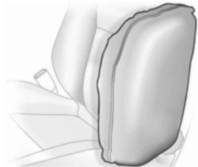
Os airbags cheios amortecem o impacto, reduzindo consideravelmente o risco de ferimentos na parte superior do corpo e da pélvis, no caso de colisão lateral.
