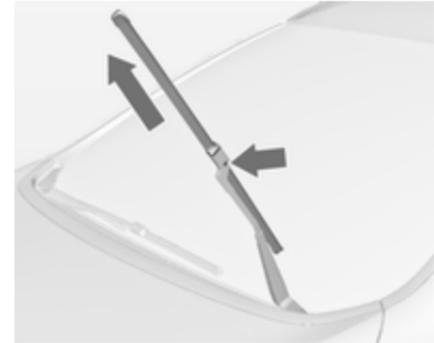
Levantar o braço do limpa-vidros até se manter na posição levantada, pressionar o botão, desencajar a escova e retirá-la.
