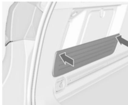
Na montagem, pressionar a cortina nos olhais de borracha para atingir completamente a força de retenção.
