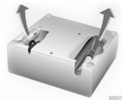
3. Retirar o cabo de ligação eléctrica e tubo flexível de ar do compartimento de arrumação que se encontram na parte inferior do compressor.
