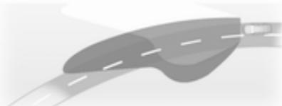
Os feixes dos faróis rodam conforme o ângulo do volante e a velocidade, melhorando a iluminação nas curvas.
