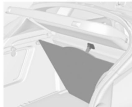
A cobertura do piso traseiro pode ser levantada. Introduzir a argola no gancho no lado inferior da cobertura da bagageira.
