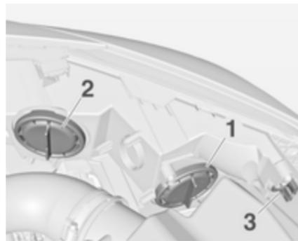
**Faróis bi-halógeno (1)** com uma lâmpada para luzes de máximos e de médios.
