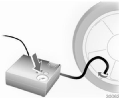
Se a pressão do pneu for superior a 1,3 bar, corrigir para o valor correcto. Repetir o procedimento até deixar de haver perda de pressão.
