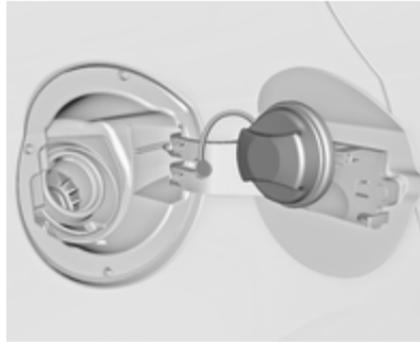
A tampa do tubo de enchimento de combustível pode ser colocada no suporte, na portinhola do depósito de combustível.
