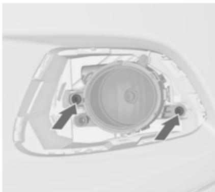
2. Desapertar os dois parafusos e retirar o conjunto da lâmpada.
