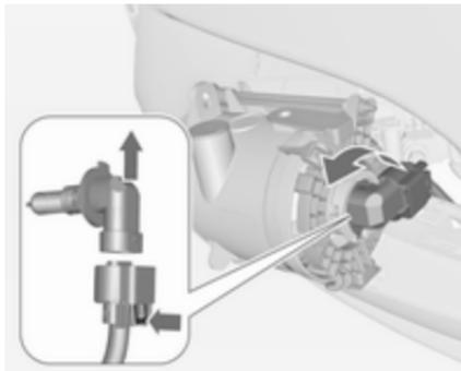
3. Rodar o suporte da lâmpada para a esquerda e retirá-lo do refletor.
