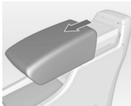
O apoio para o braço pode ser deslizado 10 cm para a frente. Sob o apoio para os braços existe um compartimento para arrumação.
