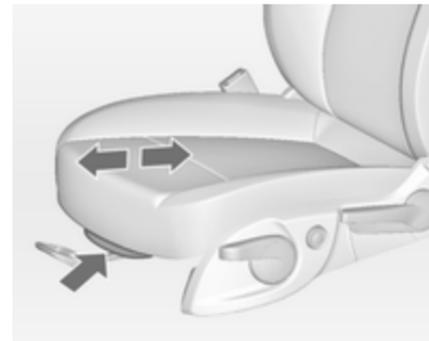
Puxar a alavanca e deslizar o apoio para as ancas.
