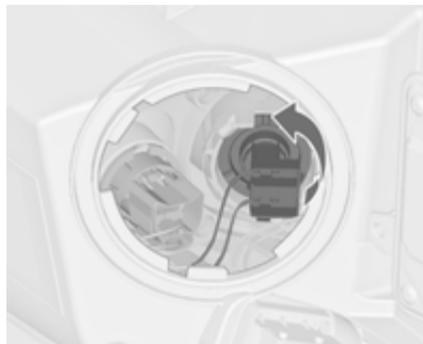
2. Rodar o suporte da lâmpada para a esquerda para desencaiar. Afastar o suporte da lâmpada do reflector.
