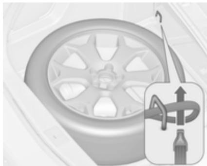
2. Passar a extremidade da cinta com laçada pelo olhal dianteiro do lado adequado.
