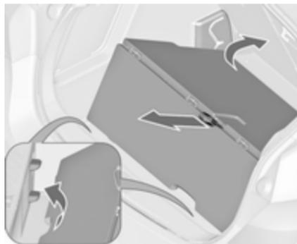
Para levantar a cobertura para um nível mais alto, puxar a argola para trás e levantar a extremidade traseira da cobertura até aos suportes correspondentes.
