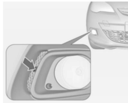
1. Desencaixar a cobertura utilizando uma chave-de-parafusos na reentrância e retirá-la.
