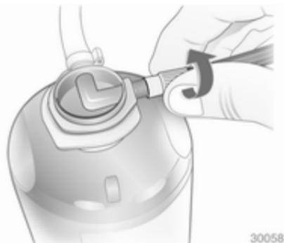
4. Aparafusar o tubo flexível do compressor na ligação na botija do vedante.
