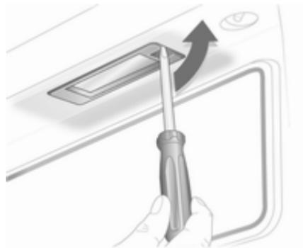
1. Inserir uma chave de parafusos na reentrância da cobertura, pressionar para o lado e soltar a mola. Retirar a cobertura.
