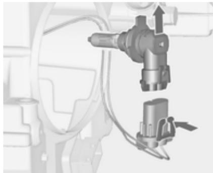
3. Desencaixar o suporte da lâmpada da ligação da ficha, pressionando a presilha de retenção.
