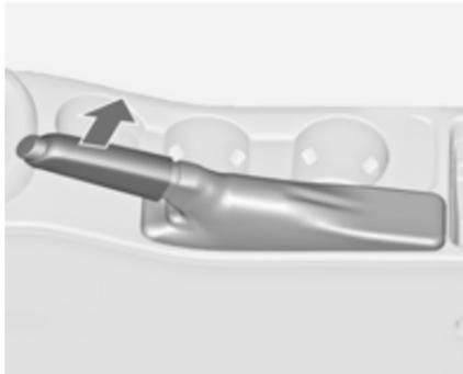
Aplicar sempre o travão de mão com firmeza sem accionar o botão de destravagem e aplicar tão firmemente quanto possível numa subida ou descida.
