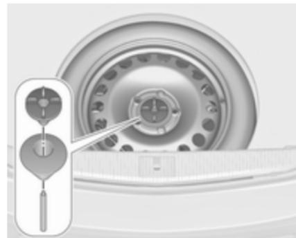
3. Posicionar o cone na cavidade para a roda sobresselente e fixá-lo rodando a porca de orelhas.
