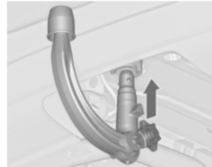
Insira a barra da esfera de acoplamento sob tensão na abertura e empurrar firmemente para cima até se ouvir a engatar.
