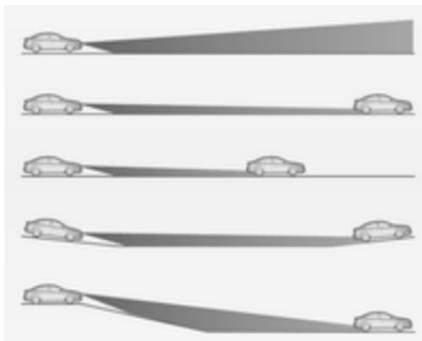
Uma função de avaliação topográfica especial detecta veículos à frente em subidas ou lombas, detectando as luzes traseiras a moverem-se em frente. O sistema ajusta a altura do foco de luz para garantir uma iluminação otimizada da estrada à frente do veículo sem produzir encadeamento.
