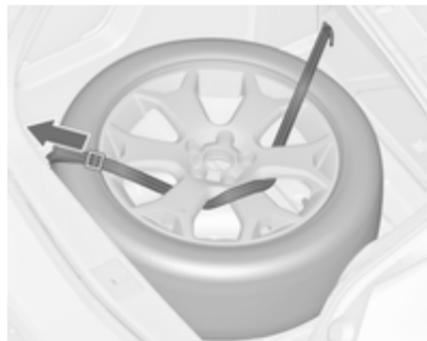
4. Inserir a cinta pelos raios da jante, conforme se mostra na figura.
