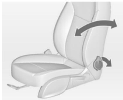
Puxar a alavanca, regular a inclinação e soltar a alavanca. Deixar que o encosto do banco traseiro encaixe até ouvir o barulho de encaixe.
