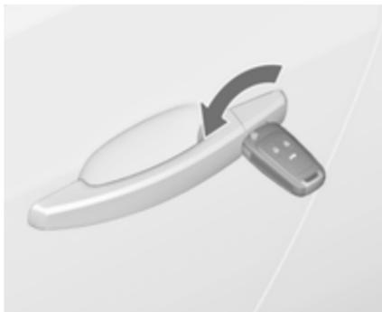
Destrancar manualmente a porta do condutor rodando a chave na fechadura. Ligar a ignição e pressionar o botão do fecho centralizado
