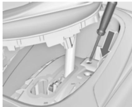
3. Inserir uma chave de parafusos na abertura até onde avançar e deslocar a alavanca para fora do **P** ou **N**. Se o **P** ou **N** for novamente engatada, a alavanca selectora ficará novamente bloqueada. Reparar a causa da interrupção de alimentação eléctrica numa oficina.
