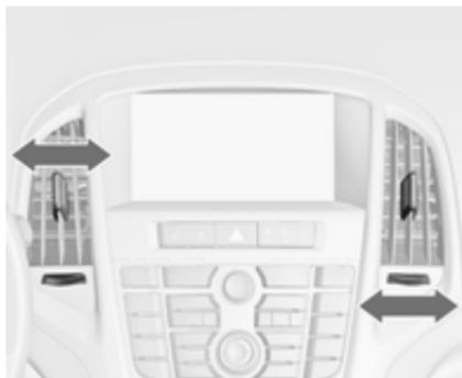
Para abrir a grelha, rodar a roda de regulação no sentido do símbolo ■ maior. Ajustar a quantidade de ar na saída de ar, rodando o botão rotativo de ajuste.
