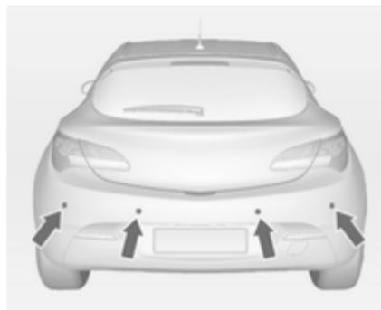
A assistência de estacionamento facilita o estacionamento medindo a distância entre o veículo e os obstáculos emitindo sinais acústicos.
