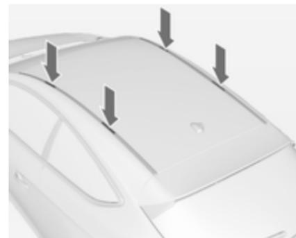
Utilizando uma moeda, separar a cobertura de cada ponto de encaixe.
