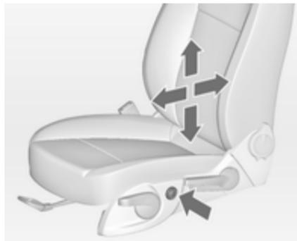
Ajustar o apoio lombar usando o interruptor de quadro vias para o adaptar às necessidades pessoais.
