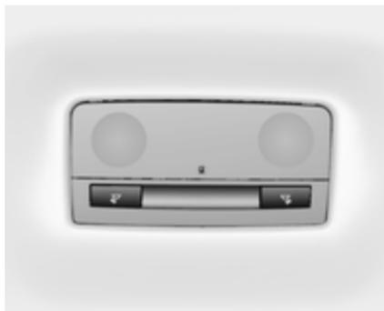
Acendem em conjunto com a luz dianteira de cortesia dependendo da posição do interruptor de balancim.
