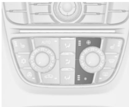
Pressionar o botão inferior para diminuir ou o botão superior para aumentar a velocidade da ventoinha conforme ilustrado. A velocidade da ventoinha é indicada pelo número de segmentos no visor.
