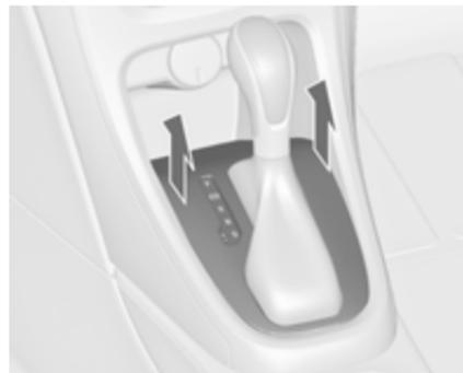
2. Soltar o forro da alavanca selectora na parte da frente da consola central, dobrá-la para cima e rodá-la para a esquerda.
