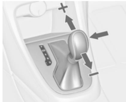
Retirar a alavanca selectora da posição **D** e deslocar para a esquerda e depois para a frente ou para trás.
