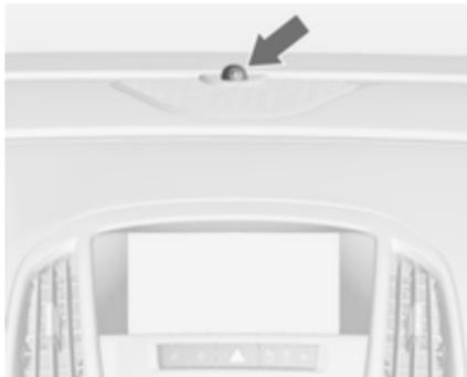
O LED de estado está integrado no sensor acima do painel de instrumentos.
