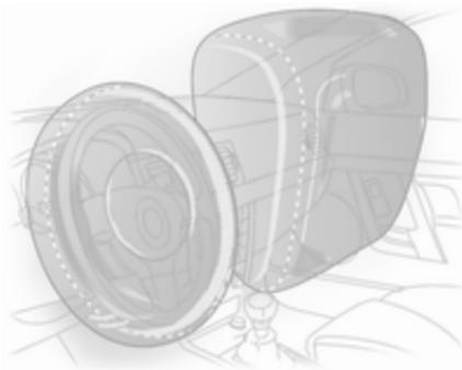
Os airbags cheios amortecem o impacto, reduzindo consideravelmente o risco de ferimentos na parte superior do corpo e cabeça dos passageiros da frente.
