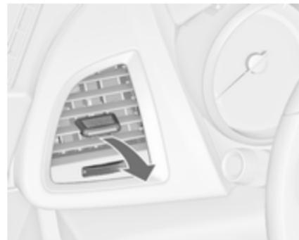
Direccionar o fluxo de ar inclinando e girando as palhetas.
