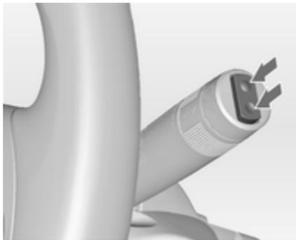
Pressionar o interruptor basculante para accionar o limpa-vidros do óculo traseiro:
