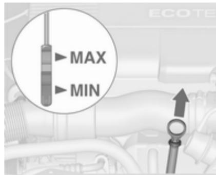
Quando o nível do óleo de motor for inferior à marca **MIN**, atestar com óleo de motor.
