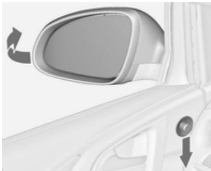
Rodar o comando para 0, e pressionar o comando para baixo. Ambos os retrovisores exteriores recolherão.
