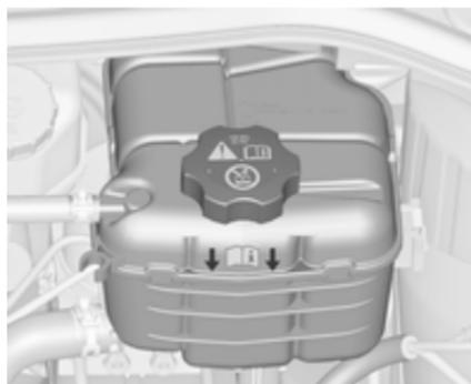
Se o sistema de arrefecimento estiver frio, o nível do líquido de arrefecimento deve estar acima da marca de enchimento. Atestar se o nível estiver baixo.
