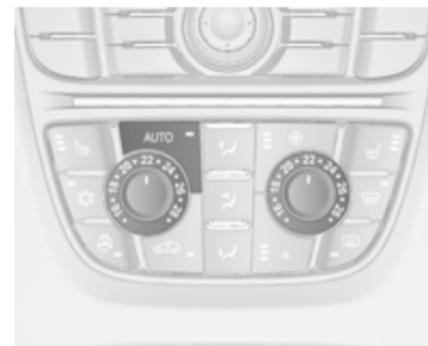
Se for definida a temperatura mínima, o sistema de controlo de climatização funciona em arrefecimento máximo.
