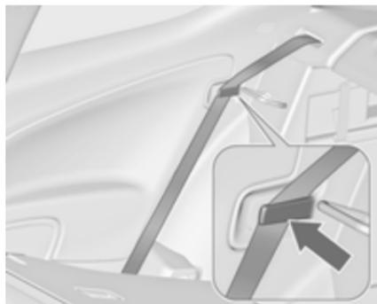
Retirar o cinto de segurança da guia do encosto do banco e colocá-lo atrás do retentor, conforme se mostra na ilustração.
