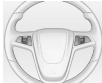
O Sistema de informação e lazer, o programador de velocidade e um telemóvel ligado podem ser comandados através dos comandos no volante.
