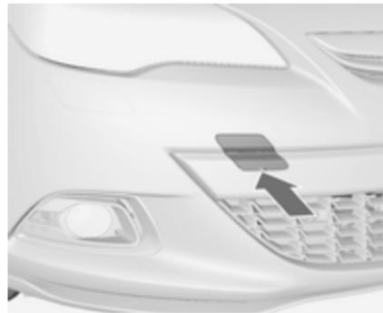
Inserir uma chave de parafusos na fenda existente na curvatura inferior da tampa. Soltar a tampa deslocando cuidadosamente a chave de parafusos para baixo.
