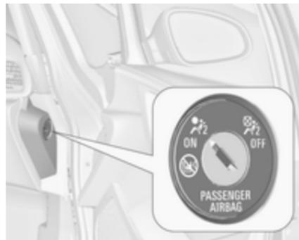
O sistema de airbag do passageiro da frente pode ser desactivado através de um interruptor accionado por chave na lateral direita do painel de instrumentos.
