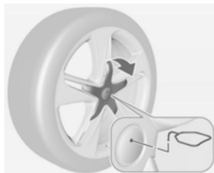
Jantes de liga com tampa dos parafusos centrais: Desencaixar a tampa central inserindo e puxando a ferramenta extractora ⇨ 188 na reentrância do emblema da marca.
