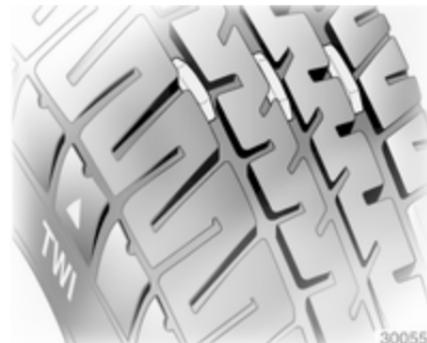
A profundidade de rasto mínima permitida por lei (1,6 mm) terá sido atingida quando o rasto tiver sido gasto até um dos indicadores de desgaste do rasto (TWI). A respectiva posição está indicada por marcas na parede lateral.
