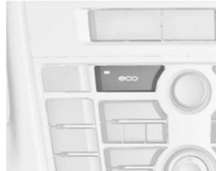
Desactivar manualmente o sistema Start/Stop carregando no botão **eco**. A desactivação é indicada quando o LED no botão se apaga.
