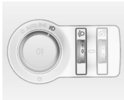
Para adaptar o alcance dos faróis à carga do veículo, para evitar encandeamento: rodar o botão de accionamento manual
