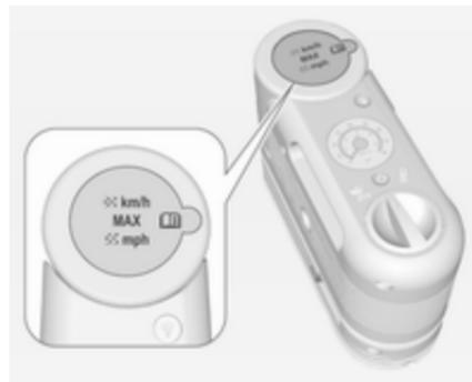
16. **Vedante e tubo flexível de ar:** Se o pneu vazio tiver sido cheio à pressão recomendada, retirar a etiqueta de indicação de limite máximo de velocidade do recipiente do vedante e colocá-lo em local bem visível. Não exceder a velocidade recomendada na etiqueta até que o pneu danificado seja reparado ou substituído.
