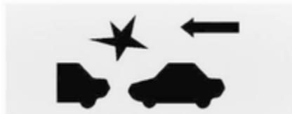
Se o seu veículo se aproximar demasiado depressa de outro veículo, o visor de aviso de colisão dianteira fica intermitente e emite vários avisos sonoros. Quando isto acontece, o sistema de travagem prepara para a travagem do condutor se verificar mais rapidamente.
