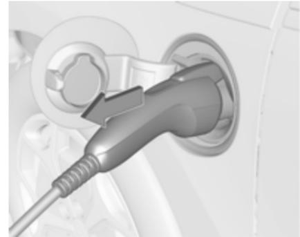
2. Retirar a ficha do veículo do cabo de carga do veículo.
