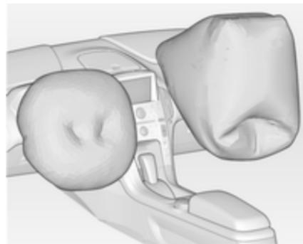
O sistema de airbag dianteiro dispara no caso de impacto frontal de determinada gravidade. A ignição necessita de ser ligada.
