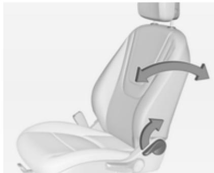
Puxar a alavanca, ajustar a inclinação e soltar a alavanca. Deixar que o banco encaixe até ouvir o barulho de encaixe.
