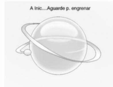
Uma mensagem áudio de boas-vindas, de prontidão e de adeus será emitida no veículo e animada no conjunto de instrumentos ao abrir a porta do condutor e na entrada, quando o veículo está pronto para ser conduzido e quando a ignição é desligada. O conjunto de instrumentos apresenta um indicador de nível de carga da bateria e de combustível, assim como um sinal sonoro de aviso de arranque se o veículo estiver pronto para ser conduzido.
