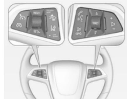
O Sistema de informação e lazer, o programador de velocidade e alguns sistemas auxiliares do condutor podem ser comandos através dos comandos no volante.
