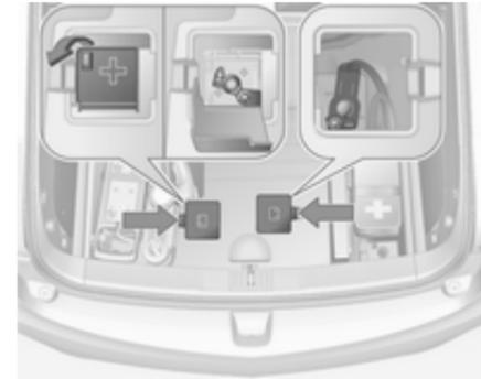
Os terminais de bateria para arranque auxiliar de outro veículo, encontram-se no compartimento do motor por baixo de duas coberturas de acesso. Abra e retire as coberturas de acesso sempre que necessite de arranque auxiliar para ligar outro veículo. O terminal positivo da bateria está coberto com uma cobertura adicional de acesso, marcada com um **+**. Abra a cobertura de acesso sempre que pretenda usar o terminal positivo da bateria.
