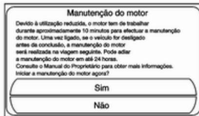
Se **Sim** for seleccionado, o modo de manutenção do motor é iniciado. O motor funciona por um determinado período de tempo sem desligar-se. Durante o modo de manutenção do motor, é apresentada uma mensagem no CIC para mostrar a percentagem concluída do modo de manutenção do motor.
