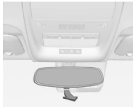
Para reduzir o encandeamento, regular com a alavanca na parte inferior da caixa do espelho retrovisor.
