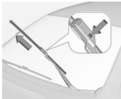
2. Premir o botão localizado no meio da junção do braço do limpa pára-brisas e puxar a lâmina de borracha para fora da junção do braço.
