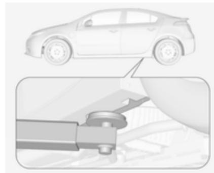
Posição do braço traseiro da plataforma de elevação na subestrutura.
