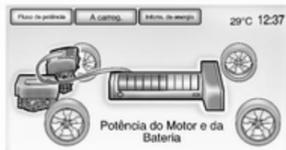
Os ecrãs **Fluxo de potência** indicam as condições actuais de funcionamento do sistema. Os ecrãs mostram os fluxos de transmissão de energia entre a unidade propulsora eléctrica e a bateria de alta tensão. Estes componentes serão destacados no grafismo quando estão activos.
