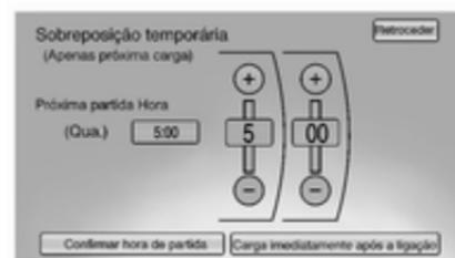
3. Premir **Carga imediatamente após a ligação** para anular temporariamente um modo de carga imediato.
