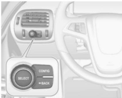
**CONFIG:** premir para seleccionar o modo simples ou o modo completo de apresentação da configuração do conjunto de instrumentos.
