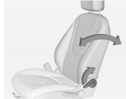
Puxar a alavanca, ajustar a inclinação e soltar a alavanca. Deixar que o encosto do banco traseiro encaixe até ouvir o barulho de encaixe.
