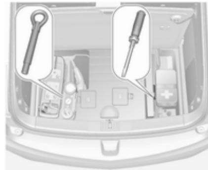
O olhal e uma chave de parafusos encontram-se debaixo de uma cobertura na bagageira. Tenha em conta que o olhal de reboque se encontra por baixo do kit de reparação de pneus.
