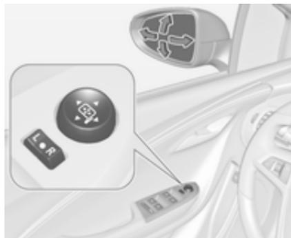
Selecione o espelho retrovisor exterior em causa, deslocando o interruptor selector para a esquerda (L) ou para a direita (R). Em seguida premir o comando para regular o respectivo espelho retrovisor.
