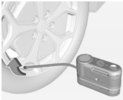
5. Ligar o tubo flexível transparente para ar/vedante ou o tubo flexível preto apenas para ar, à haste da válvula do pneu. Rodar para a direita até estar bem apertada.
