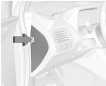
A caixa de fusíveis esquerda no painel de instrumentos fica localizada na extremidade do lado esquerdo do painel de instrumentos. Para aceder aos fusíveis, abrir a portinhola da caixa dos fusíveis puxando-a para fora.
