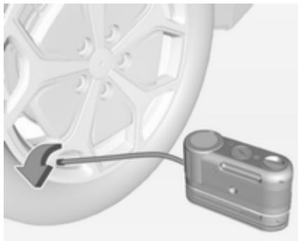
13. Rodar o tubo flexível transparente para ar/vedante ou o tubo flexível preto apenas para ar para a esquerda, para o retirar da válvula do pneu.
