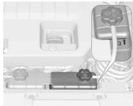
Verificar se o líquido de arrefecimento é visível no reservatório do líquido de arrefecimento dos módulos de carregamento e da electrónica da alimentação. Se for visível a existência de líquido de arrefecimento mas se este estiver abaixo do nível a frio, poderá existir uma fuga no sistema de líquido de arrefecimento.
