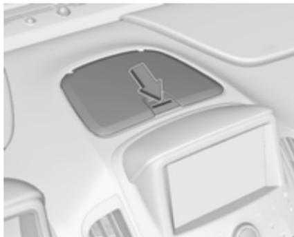
Há um compartimento para arrumação acima do painel de instrumentos.
