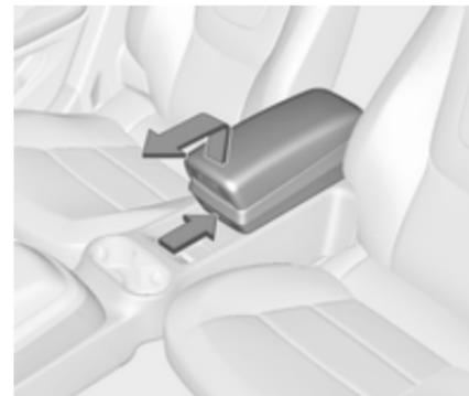
Para retirar o apoio de braços, prima o botão e puxe o apoio de braços para cima. Desloque o apoio de braços para a frente para soltá-lo do suporte traseiro.
