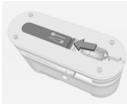
O kit de reparação de pneus tem um adaptador acessório que está localizado num compartimento na
