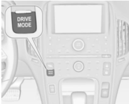
Prima **MODO DRIVE** repetidamente até o modo de condução pretendido ser destacado no Centro de Informação ao Condutor (CIC).
