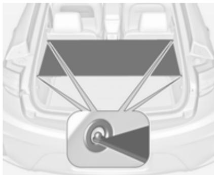
Utilizar os quatro olhais para engatar e cobrir a tampa aos painéis laterais.
