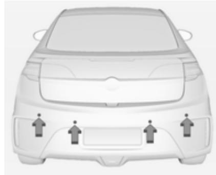
Os sensores de estacionamento ultra-sónicos facilitam o estacionamento medindo a distância entre o veículo e os obstáculos emitindo sinais acústicos. É no entanto o condutor que continua totalmente responsável pelo acto de estacionar.
