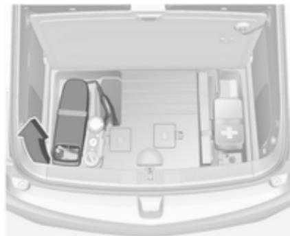
Puxar a pega do cabo de carga para libertá-lo da mola de fixação da pega. Levantar e puxar o cabo de carga para trás para o retirar do veículo. A ficha de ligação ao veículo é guardada como é apresentado.
