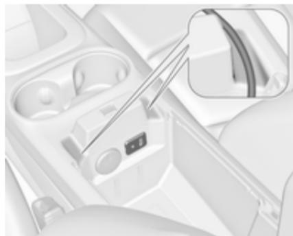
Uma entrada USB e uma tomada AUX encontram-se no interior da consola de piso dianteira. Os cabos podem ser encaminhados através do passa-cabos.
