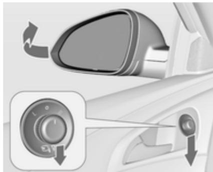
1. Se o veículo estiver equipado com espelhos retrovisores de rebatimento eléctrico, desloque o interruptor de selecção para ● para desseleccionar o espelho retrovisor.
