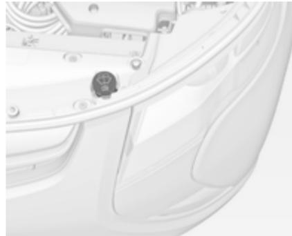
Ao adicionar líquido limpa-vidros no veículo, certificar-se que lê as instruções do fabricante antes de o utilizar. Se usar o veículo em áreas onde as temperaturas podem ser negativas, use um líquido com protecção suficiente anti-congelante.
