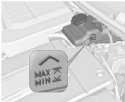
Se o veículo não tiver estado a funcionar há pelo menos 1 minuto, o nível máximo do líquido está no topo do corpo do depósito. Com o veículo a funcionar, o nível do fluido deve estar dentro do intervalo de funcionamento correcto entre as
