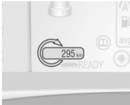
Apresenta a autonomia total do veículo associando a autonomia eléctrica e a autonomia com combustível.
