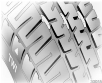
A profundidade mínima do relevo permitida por lei (1,6 mm) terá sido atingida quando o relevo tiver sido gasto até um dos indicadores de desgaste do relevo (TWI). A respectiva posição está indicada por marcas na parede lateral.
