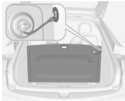
2. Abrir a porta da bagageira, levantar a cobertura do piso e com a argola, prender a cobertura ao painel lateral.
