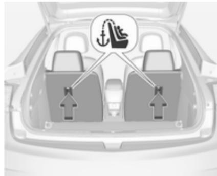
Os olhais de fixação Top-tether para assentos voltados para a traseira do veículo estão localizados na parte de trás do encosto do banco traseiro. Assegurar-se de que é utilizado um olhal de fixação nesse lado do veículo onde o sistema de segurança para crianças será instalado.
