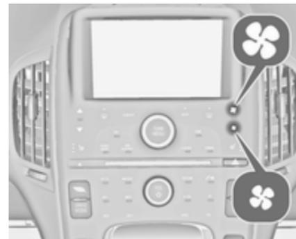
Premir os botões de comando do ventilador 🌀 no painel de instrumentos ou no comando do ventilador no ecrã tátil, para aumentar ou diminuir a velocidade do ventilador.
