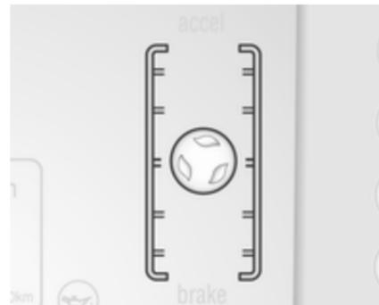
Este indicador é um guia para ajudar a uma condução eficiente mantendo a esfera verde no centro do indicador. As folhas param de rodar quando o veículo pára ou quando a esfera se desloca para fora do centro do medidor.
