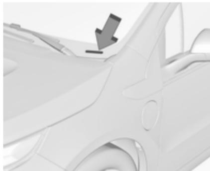
O Número de Identificação do Veículo (VIN) localiza-se no canto esquerdo dianteiro do painel de instrumentos. É visível através do pára-brisas.
