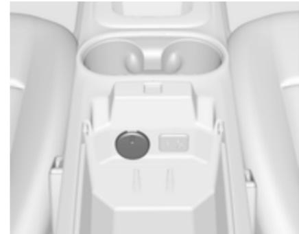
As saídas de alimentação de 12 volt encontram-se no compartimento de arrumação no apoio de braços dianteiro e na consola de piso traseira central.
