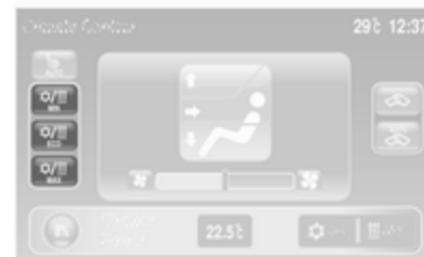
Podem ser seleccionadas três definições diferentes do modo de climatização. Estas definições regulam o impacto que o sistema de climatização tem na autonomia eléctrica do veículo ou na economia de combustível.
