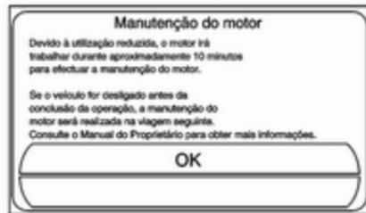
Se o veículo for desligado durante o modo de manutenção do motor, este recomeçará da próxima vez que o veículo for conduzido. É apresentada uma mensagem para indicar que o modo de manutenção do motor está activo.
