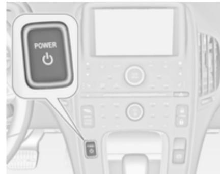
O veículo está equipado com um botão de pressão electrónico de arranque. A luz do botão  $\odot$  fica intermitente quando a porta do condutor é aberta e a ignição não está ligada. A luz intermitente
