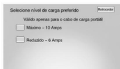
A escolha do nível de carregamento deve ser configurada para igualar a intensidade nominal da corrente eléctrica na tomada de CA à qual é ligado o cabo de carga. As definições de escolha do nível de carregamento são:
