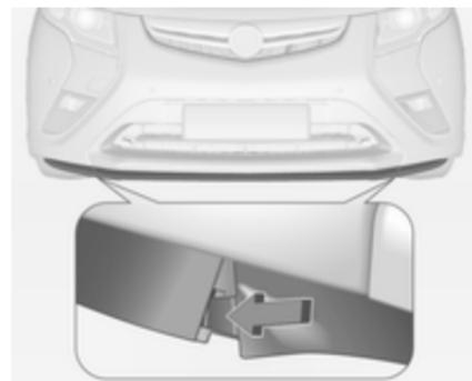
O deflector de ar dianteiro direciona o fluxo de ar sob o veículo. Caso se separe, inserir o separador na ranhura. Se necessário, repetir do outro lado.
