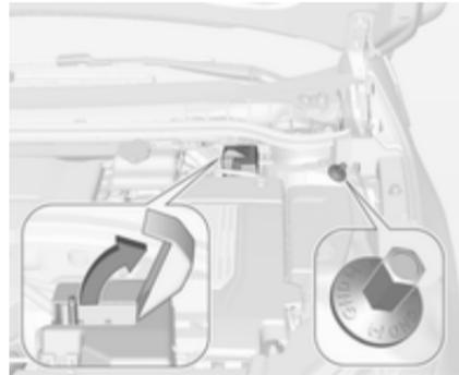
Os terminais da bateria para arranque auxiliar encontram-se no compartimento do motor. O terminal positivo da bateria encontra-se por baixo de uma cobertura de acesso. Abra a cobertura sempre que necessitar de arranque auxiliar para ligar o veículo. O terminal negativo da bateria é um perno marcado com GND.
