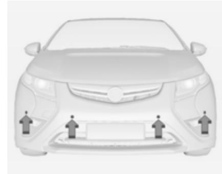
Os Sensores de estacionamento ultra-sónicos funcionam a velocidades inferiores a 8 km/h. Os sensores localizados nos pára-choques dianteiro e traseiro detectam objectos até 1,2 m de distância na frente do veículo e até 2,5 m de distância na traseira do veículo e até uma altura acima do solo de pelo menos 25 cm.
