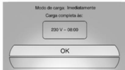
O veículo inicia o carregamento no momento em que é ligado a uma tomada eléctrica de alimentação. Carga ↻ 144.
