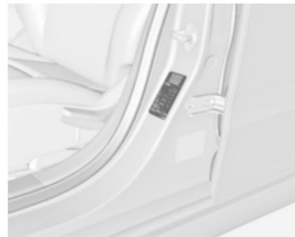
A etiqueta do pneu e de carga que se encontra no pilar da porta esquerda dianteira, indica o tipo de pneu de origem e a pressão dos pneus.
