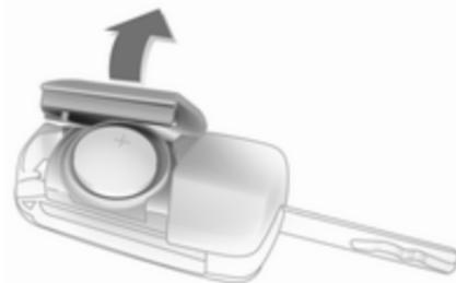
Extrair a chave e abrir a unidade. Substituir a bateria (bateria de tipo CR 2032), prestando atenção à posição de colocação. Fechar a unidade e verificar o funcionamento do radiotelecomando.
