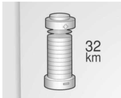
Apresenta o nível de carga e a autonomia da bateria de alta tensão.
