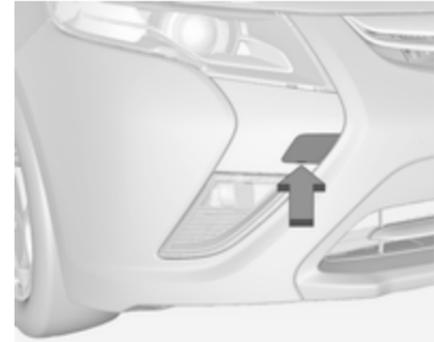
Inserir uma chave de parafusos na ranhura curta da tampa. Soltar a tampa, deslocando cuidadosamente a chave de parafusos para o lado. Para evitar danos, recomenda-se colocar um pano entre a chave de parafusos e o aro.
