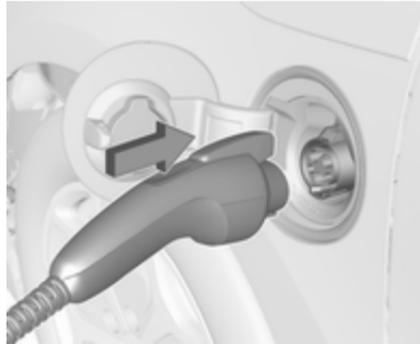
4. Encaixar a ficha de ligação ao veículo do cabo de carga na tomada de carga do veículo. Verificar que o indicador do estado de carregamento acende a verde na parte superior do painel de instrumentos e que ocorre o toque curto da buzina. Estado do carregamento ⇨ 148.
