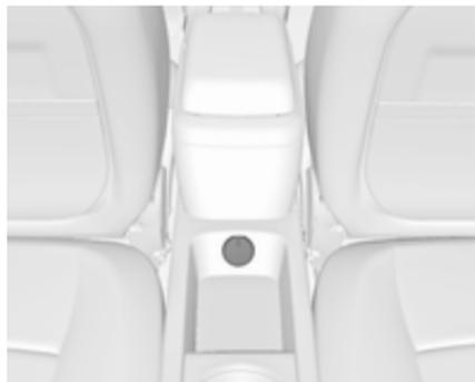
Além disso, uma saída de alimentação de 12 volt encontra-se no interior do compartimento de arrumação do painel de instrumentos.
