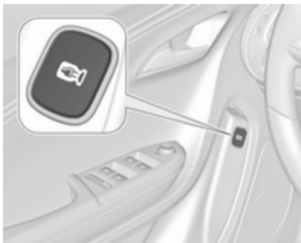
1. Com o veículo engrenado em **P**, premir
