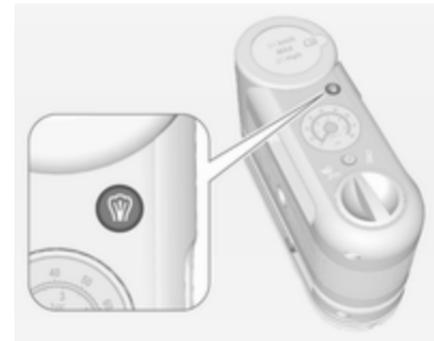
**Tubo flexível apenas para ar:** Se encher o pneu a uma pressão superior à recomendada, pode libertar a pressão em excesso premindo até que a pressão correcta tenha sido atingida.
