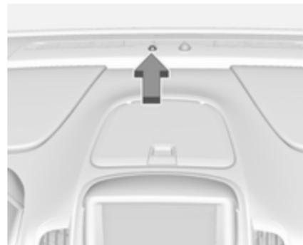
O veículo tem um indicador do estado de carregamento no centro do painel de instrumentos perto do limpa pára-brisas. Quando o veículo é ligado à alimentação mas o veículo está desligado, o indicador do estado de carregamento mostra o seguinte:
