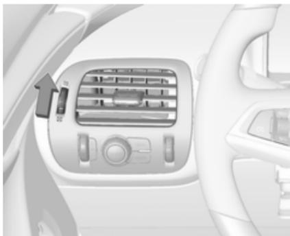
Para abrir a saída de ar, rodar o regulador para ☰. Rodar o botão rotativo na saída das grelhas de ventilação para regular o caudal do ar.
