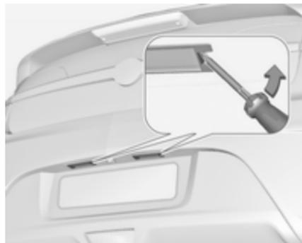
1. Premir para a esquerda a mola de fixação na extremidade direita do farolim da matrícula para desengatar o conjunto do farolim da matrícula.
