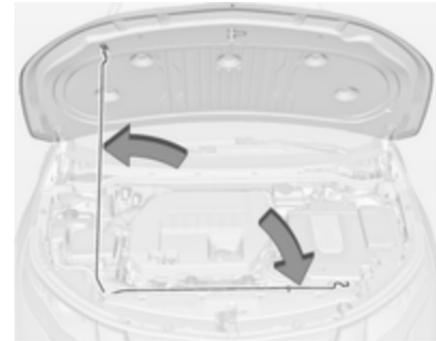
4. Libertar a haste de suporte do retentor por cima do apoio do radiador e colocá-la seguramente no encaixe retentor localizado no capot.
