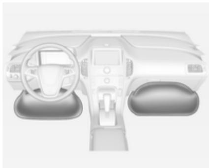
Com os airbags de protecção do joelhos, a palavra **AIRBAG** aparecerá na parte inferior do painel de instrumentos.
