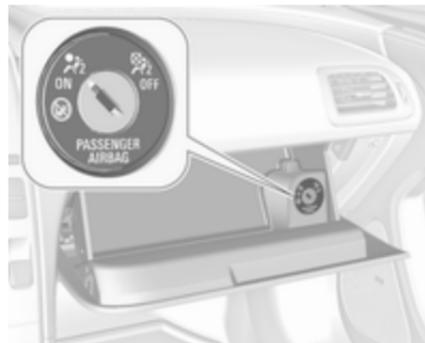
O sistema de airbags do passageiro dianteiro podem ser desactivados através de um interruptor manobrado por chave e localizado no interior do porta-luvas.
