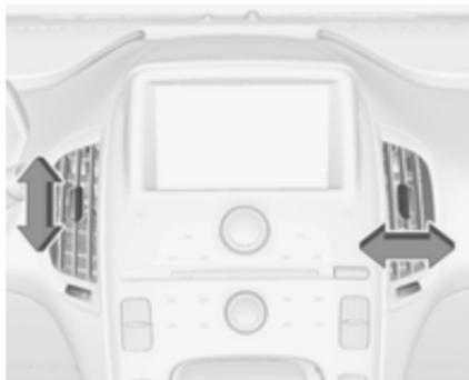
Incline e rode as réguas para direccionar o caudal do ar.
