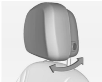
Para regular na horizontal, puxar o encosto de cabeça para a frente. O encosto de cabeça encaixa em várias posições.
