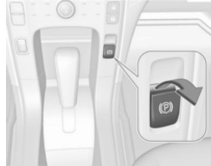
O travão de mão eléctrico pode ser activado, mesmo se a ignição estiver desligada. Para impedir que a bateria de 12 volt esgote, evitar ciclos repetidos do sistema do travão de mão eléctrico, com a ignição desligada.
