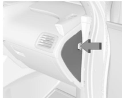
A caixa de fusíveis direita no painel de instrumentos fica localizada na extremidade do lado direito do painel de instrumentos. Para aceder aos fusíveis, abrir a portinhola da caixa dos fusíveis puxando-a para fora.
