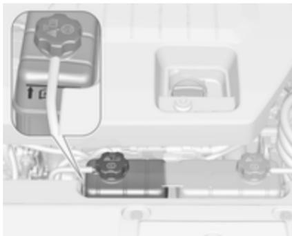
Verificar se é visível líquido de arrefecimento no reservatório de líquido de arrefecimento da bateria de alta tensão. Se for visível a existência de líquido de arrefecimento mas se este estiver abaixo do nível a frio, poderá existir uma fuga no sistema de líquido de arrefecimento.
