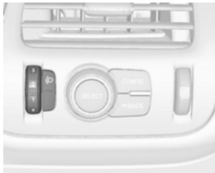
Para adaptar o alcance dos faróis à carga do veículo, para evitar encandeamento: rodar o botão de accionamento manual
