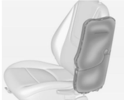
Os airbags cheios amortecem o impacto, reduzindo consideravelmente o risco de ferimentos na parte superior do corpo e da pélvis, no caso de colisão lateral.
